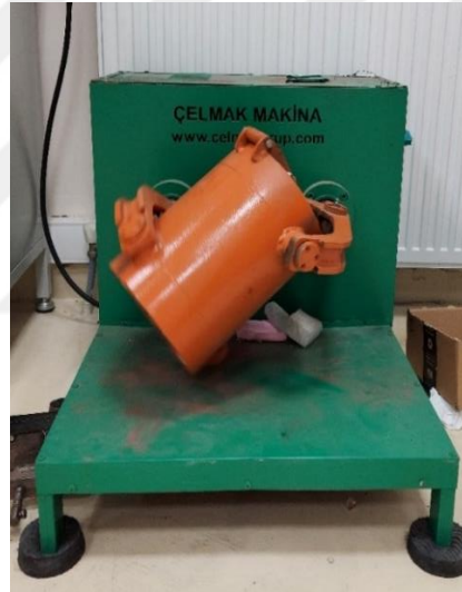
Şekil 5.3 Toz karıştırma makinesi (Turbula)
