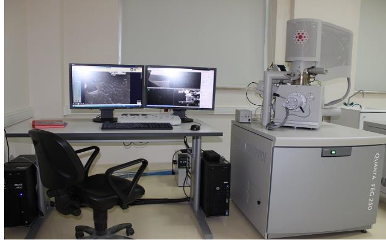
Şekil 5.14 Taramalı elektron mikroskobu
