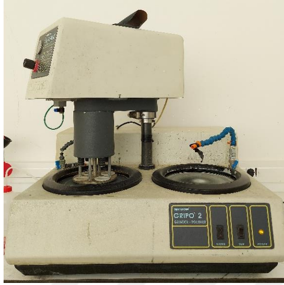
Şekil 5.11 Zımparalama ve parlatma makinesi
