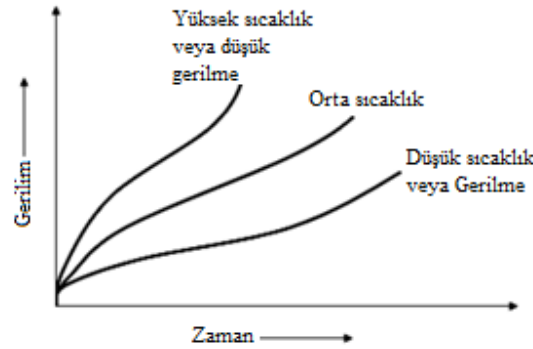
Şekil 4.10 Sıcaklığın sürünme eğrisine etkisi (Tolun, 2013)
