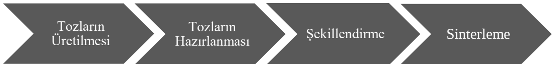
Şekil 3.8 Toz metalurjisi yöntemi ile malzeme üretiminin adımları (Gülan, 2018)
