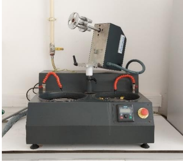
Şekil 5.8 Zımparalama ve parlatma makinesi
