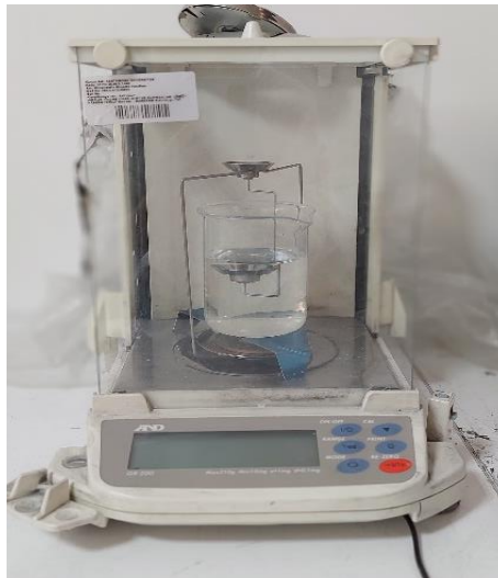
Şekil 5.19 Arşimet prensibiyle yoęunluk ölçümü
