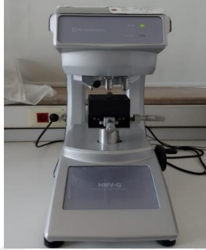
Şekil 5.18 Vickers sertlik ölçüm cihazı
