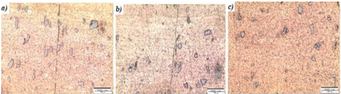
Şekil 6.6 %6 Ag-%5 SiC-%89 Cu içeren kaynaklı numunelerin birleşme bölgelerinin optik mikroskop görüntüleri a) 30dk, b) 60dk, c) 120 dk
