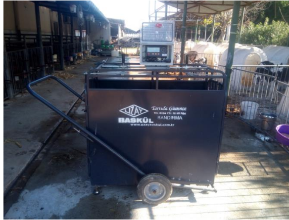
Şekil 3.2. Buzağı tartımında kullanılan seyyar dijital göstergeli kantar.
