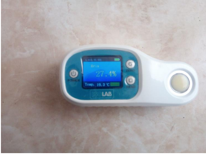
Şekil 3.3. Kullanılan Dijital Brix Refraktometre cihazı.
