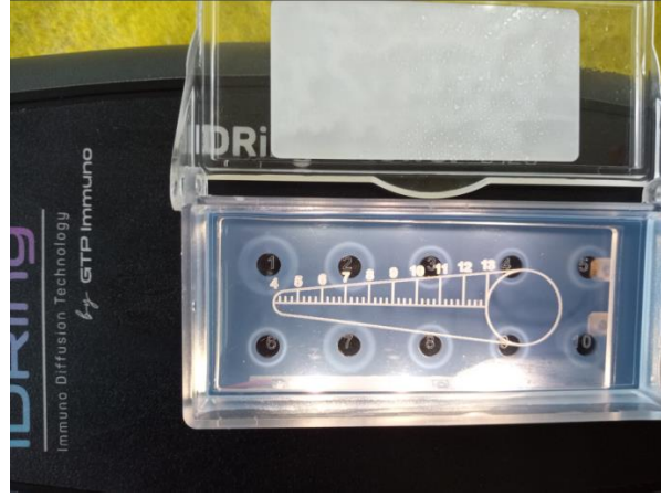
Şekil 3.7. IDRing Viewer-S® cihazı ile halka çaplarının ölçüm aşaması.
