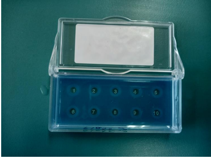
Şekil 3.6. Plaka gözlerinde reaksiyon sonrası oluşan halkalar (çap ölçümü öncesi).
