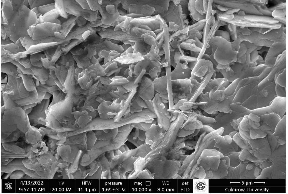
Şekil 4.4. Nb 0.00 örneğinin 10000x büyütmedeki SEM fotoğrafı.
