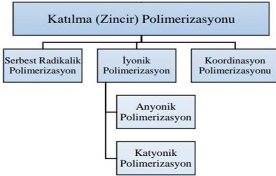
Şekil 1.14. Katılma polimerizasyonda kullanılan polimerizasyon yöntemleri (Saçak, 1998)
