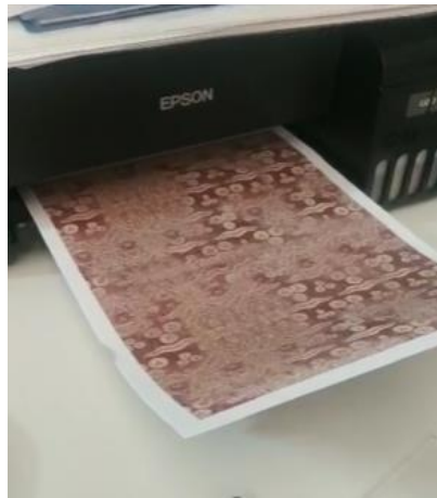
Şekil 103: Yazıcının Transfer Kağıdına Tasarımı Aktarma Aşaması
