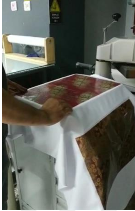
Şekil 100: Transfer Kağıdının Kumaş Üzerine Yerleştirilmesi
