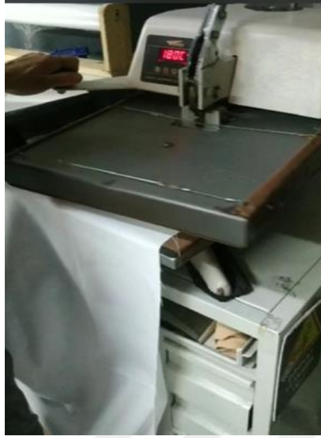
Şekil 104: Süblimasyon Transfer Baskının Isı ve Basınç Uygulaması
