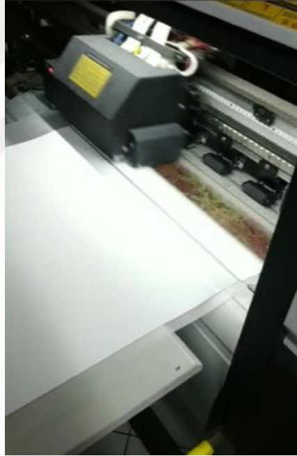
Şekil 99: Tasarımın Transfer Pet Film Kağıdına Aktarımı
