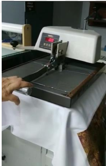
Şekil 101: Transfer Baskının Isı ve Basınçla Kumaşa Aktarılması
