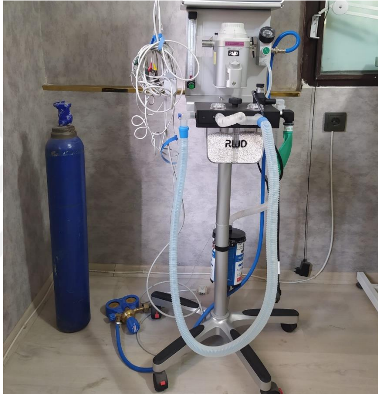
Şekil 3.1. Çalışmada kullanılan anestezi cihazı (RWD R640 veteriner anestezi cihazı).
