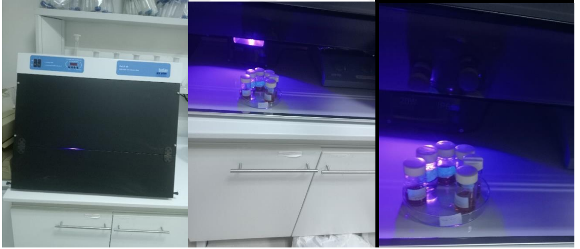
Şekil 6. [TiO 2 -Fe 3 O 4 -poli(EGDMA-N-VIM)]Mikrokürelerinin Fotokatalitik Renk Giderimi
