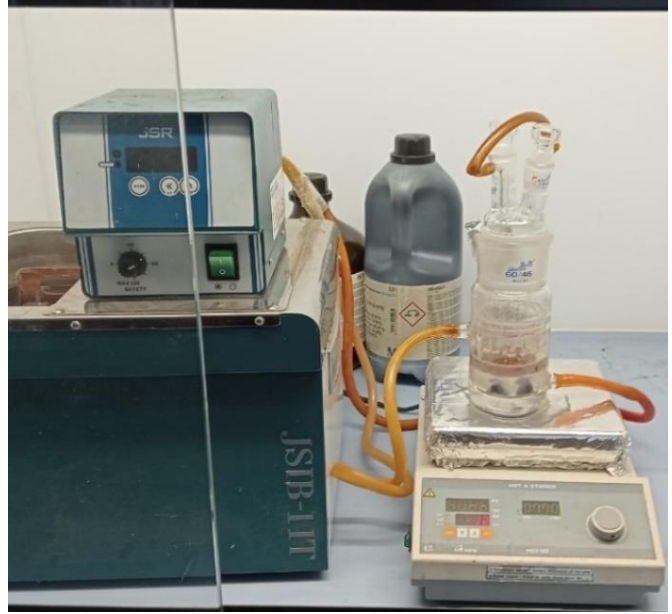
Şekil 3. Süspansiyon Polimerizasyon Metoduyla Mikrokürelerin Üretim Süreci
