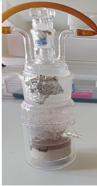
Şekil 3. Süspansiyon Polimerizasyon Metoduyla Mikrokürelerin Üretim Süreci
