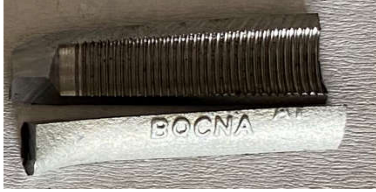
Şekil 4.12 Eğme numunesi çıkarılan kısım (Kişisel arşiv, 2022)
