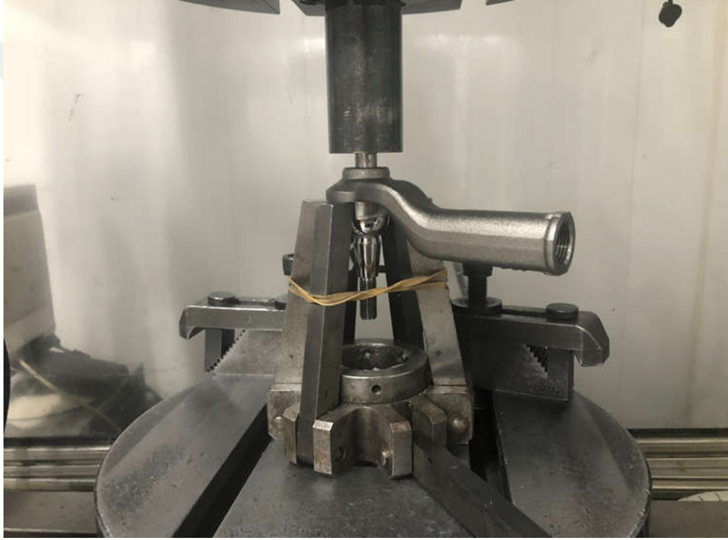
Şekil 4.1 Rot başı mafsalsal çıkma yükü testi (Kişisel arşiv, 2022)
