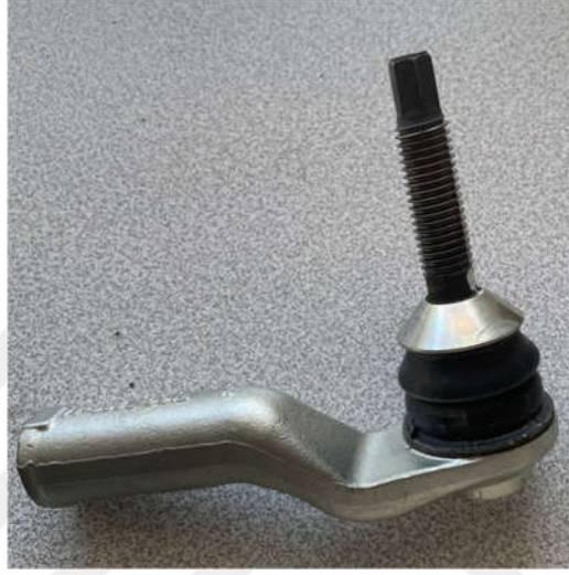
Şekil 4.2 Rot'un kesim öncesi görseli (Kişisel arşiv, 2022)
