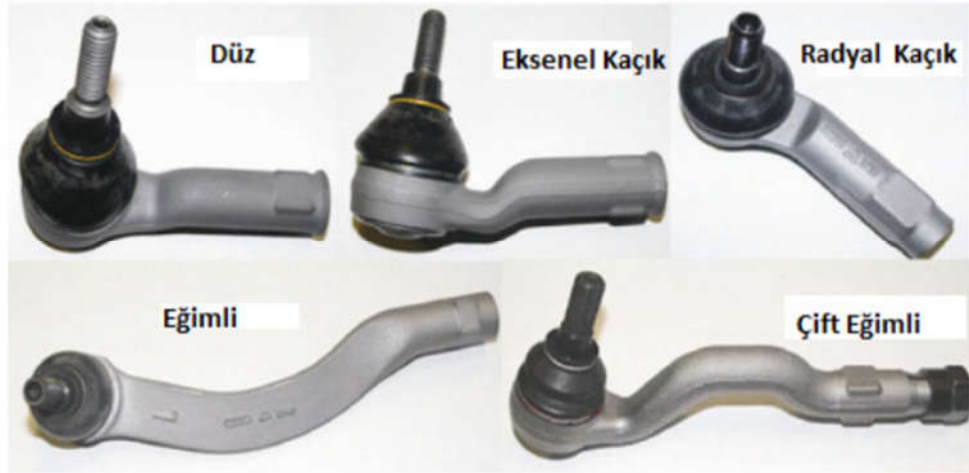
Şekil 2.21 Farklı tasarıma sahip olan rot başları (Ersoy ve Heiβing, 2011)
