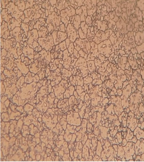
Şekil 3.33.: X+15°C' de sertleştirilmiş, temperlenmemiş çeliğin mikro yapısı, x100
