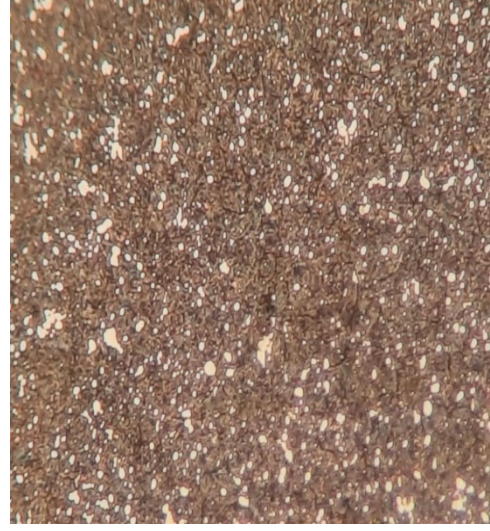
Şekil 3.34.: X+15°C' de sertleştirilmiş, temperlenmiş çeliğin mikro yapısı, x100
