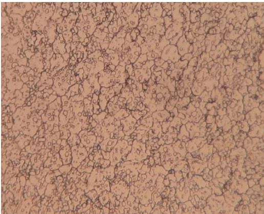
Şekil 3.31.: X+10 °C' de sertleştirilmiş, temperlenmemiş çeliğin mikro yapısı, x100
