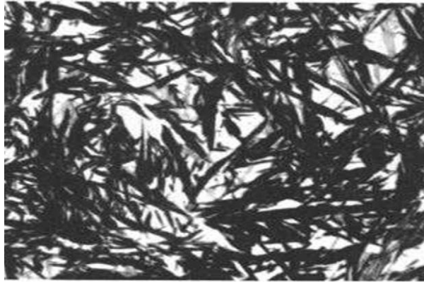
Şekil 2.7.: Yağda sertleştirilmiş takım çeliği mikroyapısı, kalıntı östenit ve martenzit mikroyapıda görülmektedir. (O1 takım çeliği, 980°C östenitleme, 220°C temperleme).
