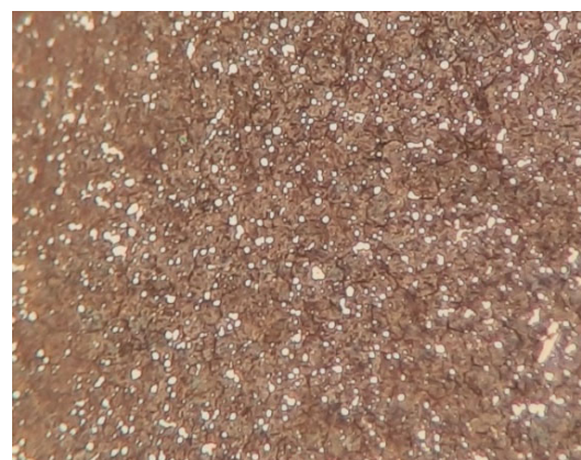
Şekil 3.32.: X+10 °C' de sertleştirilmiş, temperlenmiş çeliğin mikro yapısı, x100
