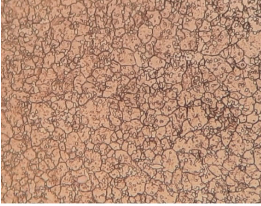
Şekil 3.27.: X °C' de sertleştirilmiş, temperlenmemiş çeliğin mikro yapısı, x100
