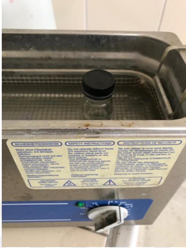
Şekil 3.3. Ultrasonik banyo içerisinde \text{TiO}_2 , PEO ve toluen çözeltisi
