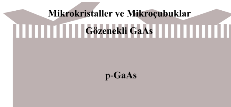
Şekil 4.24 : p-GaAs aşındırma işlemi sonucu oluşan yapının şematik anlatımı.
