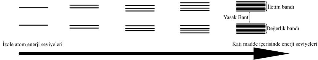
Şekil 2.2 : Bant seviyelerinin oluşumunun şematik anlatımı.
