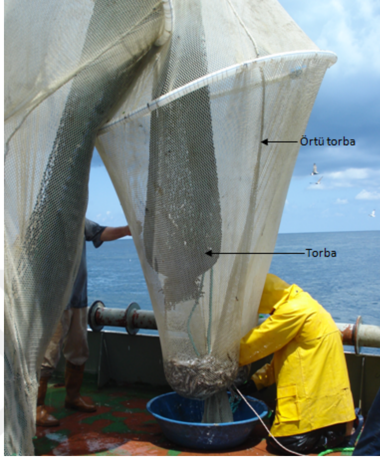
Şekil 3.13: Çekimden sonra örtü ve torba görünümü
