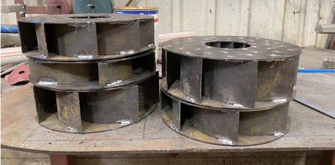
Şekil 5.7. İmalatı biten pervanelerden örnekler
