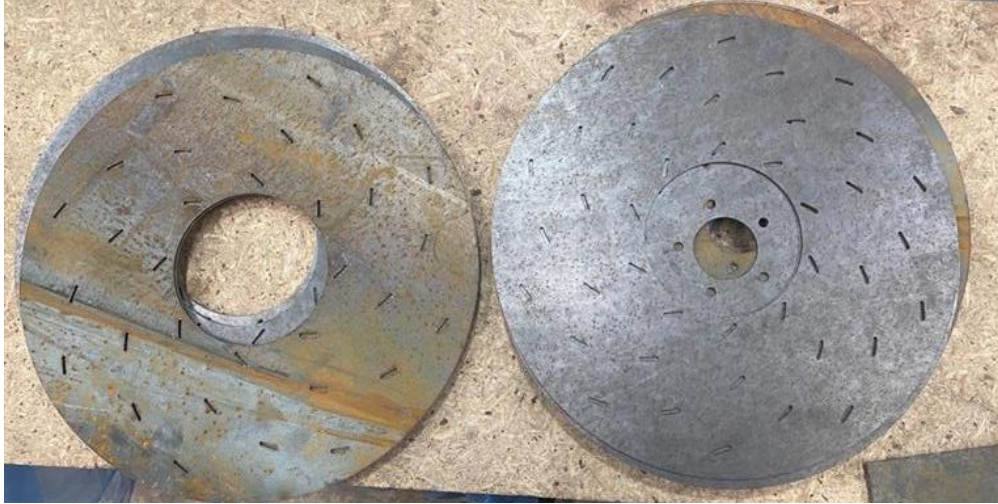
Şekil 5.2. Lazer kesim yapılan pervane plakaları
