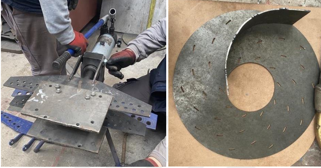
Şekil 5.6. Pervane kanatlarının istenilen eğimde büküm kalıbında bükülmesi ve yerleştirilmesi işlemi
