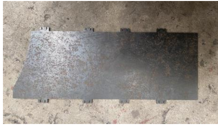
Şekil 5.4. Lazer kesim yapılan kanat plakası
