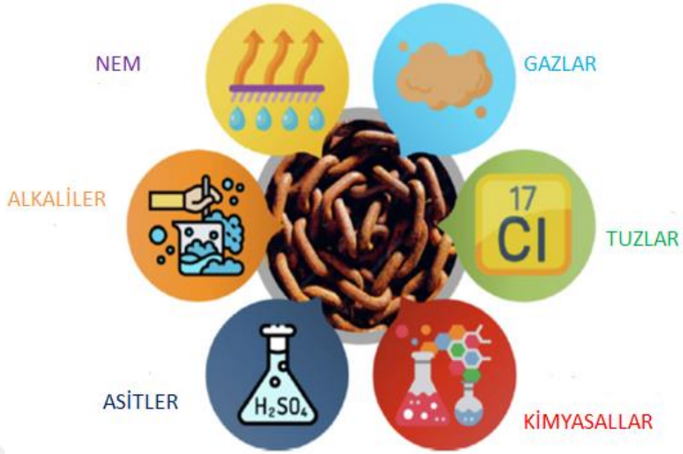
Şekil 1.4. Metallerin korozyonuna etki eden çevresel nedenler (Zakeri vd., 2022'den revize edilmiştir)
