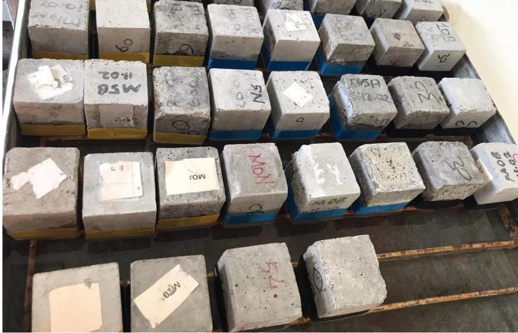
Şekil 18. Kılcal su emme deney safhası.
