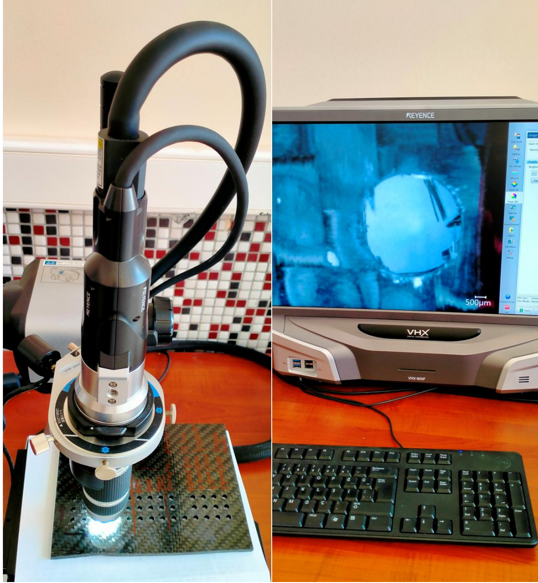
Şekil 3.4 : Keyence VHX-900F dijital mikroskop ile delaminasyon ölçümü.
