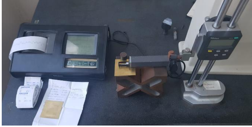
Şekil 3.6: Dokunarak taramalı yüzey pürüzlülük ölçümü
