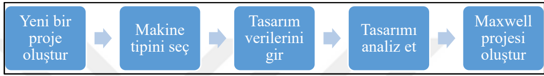
Şekil 2.1: RMxprrt elektrik makinaları tasarım akış şeması.
