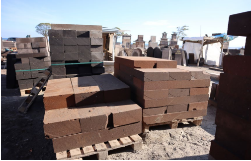
Şekil 5.5 Ahlat Ovakışla yolu üzerinde yer alan taş ocağından alınan taşların taş işleme atölyesinde işlenerek kullanıma hazır hale getirilme aşamaları (Kişisel Arşiv, 2020)
