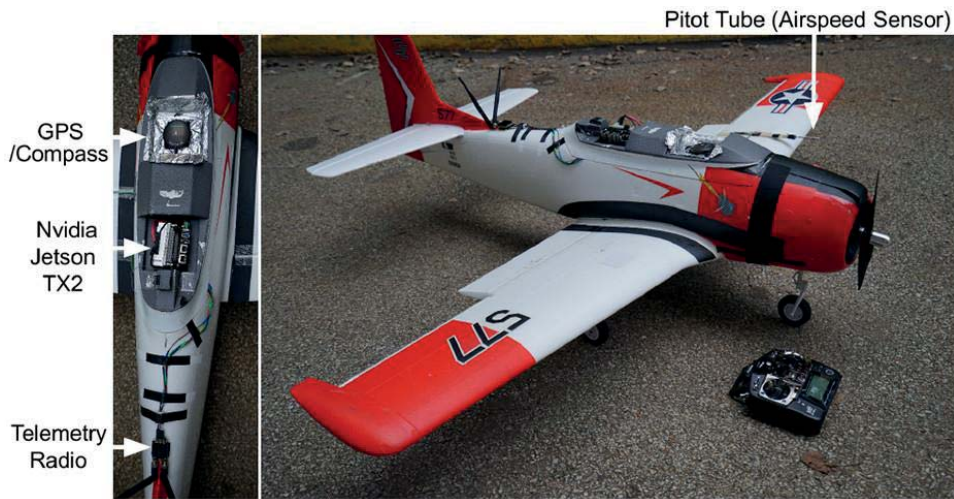
Şekil 4.1. Yerleşik Bilgisayar ve Ek Modüller ile Donatılmış Carbon-ZT-28 Modeli [28].
