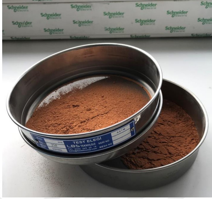
Şekil 31. Hoca Hasan Camii'ye ait numunenin elekten geçirilmesi
