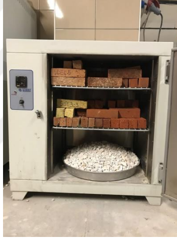
Şekil 38. Numunelerin kılcallık deneyi için etüve yerleştirilmesi
