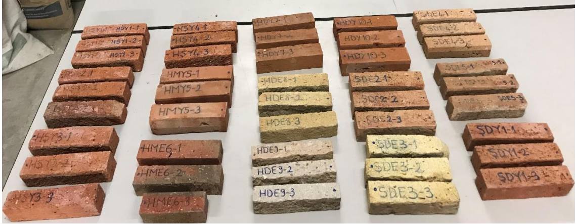
Şekil 35. Hoca Hasan Camii ve Şerafeddin Camii numunelerinin birim hacim ağırlık deneyi
