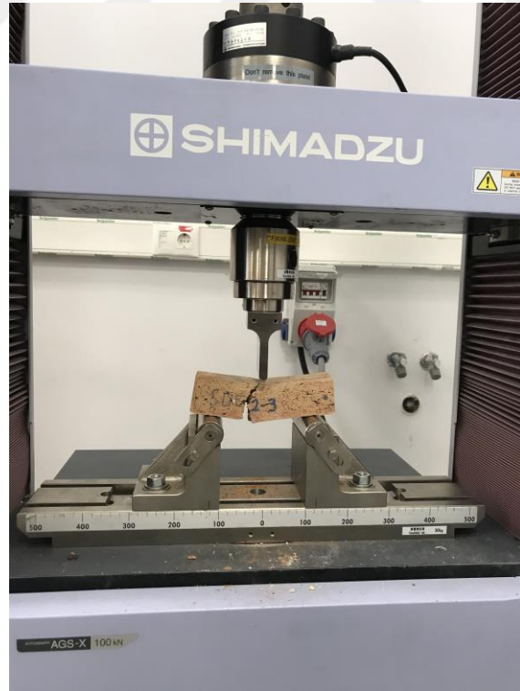
Şekil 51. Şerafeddin Camii numunesi eğilme dayanımı deneyi
