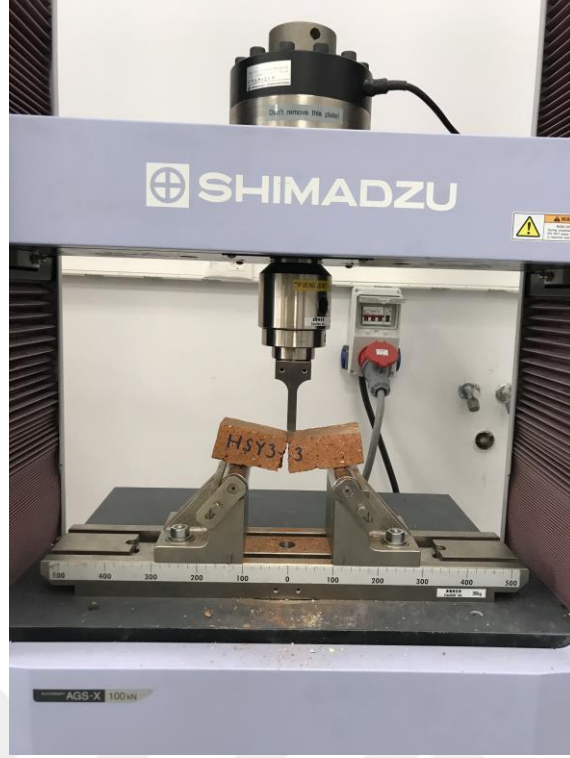
Şekil 50. Hoca Hasan Camii numunesi eğilme dayanımı deneyi
