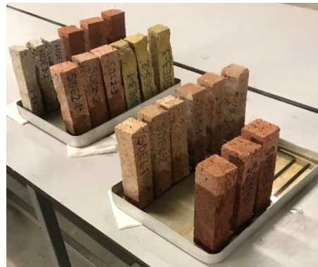
Şekil 39. Numunelerin kılcallık deneyinin gerçekleştirilmesi
