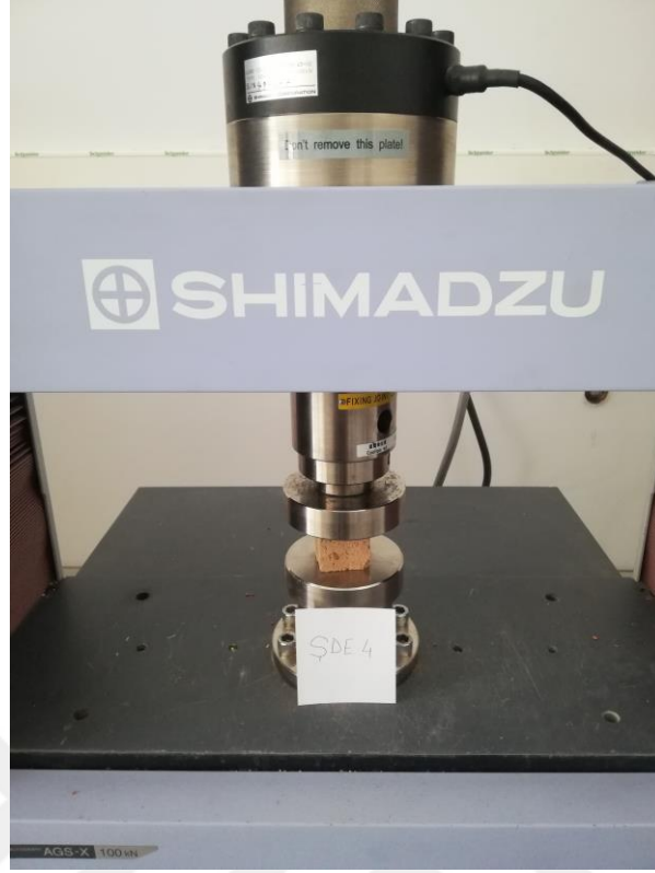
Şekil 54. Şerafeddin Camii numunesinin basınç dayanımı deneyi
