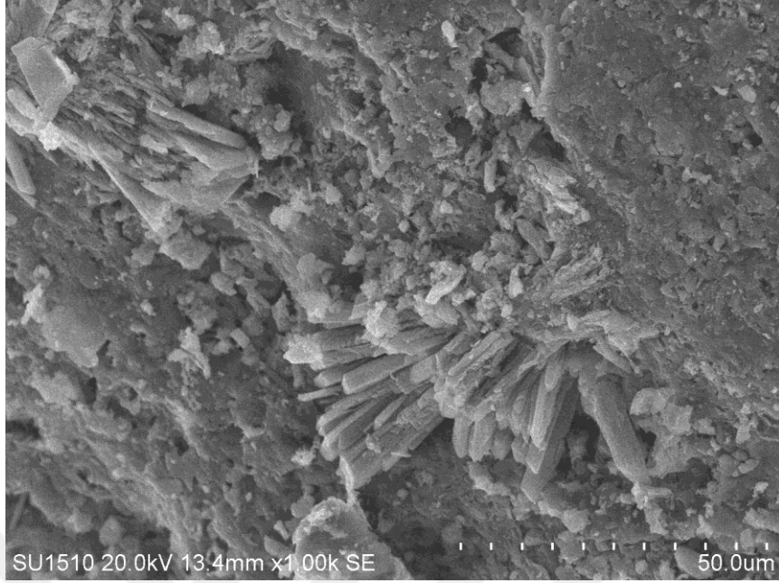
Şekil 83. ŞDY1 numunesinin 13,4 mm’lik 1000 kat büyütülmüş SEM görüntüsü
