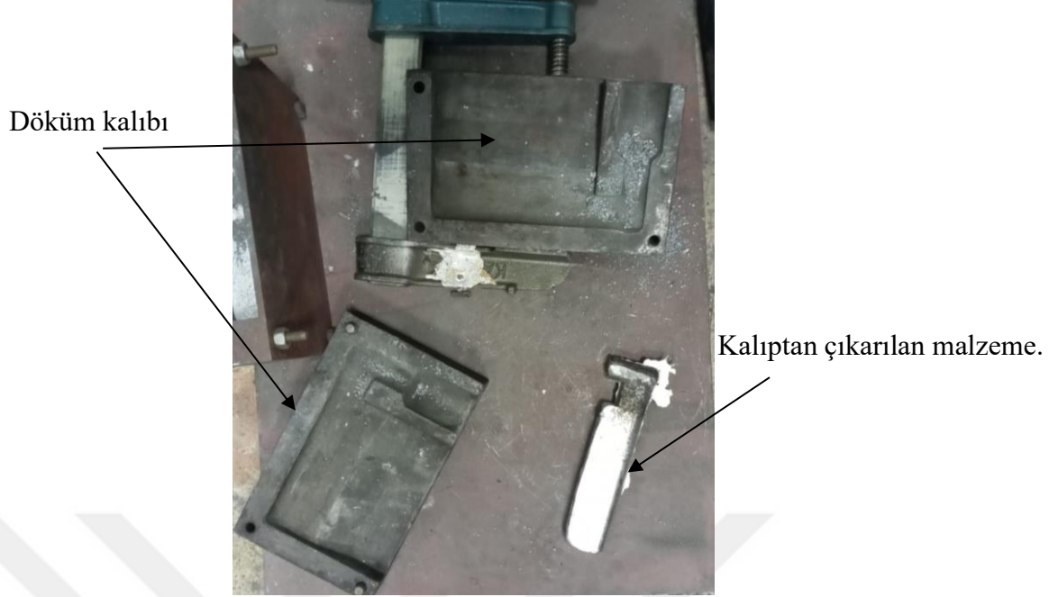
Şekil 3.7. Döküm kalıbı ve dökülen metalden elde edilen parça.
