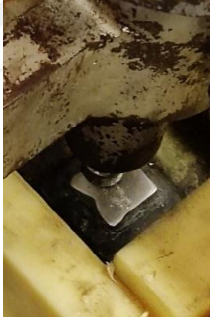
Şekil 4.9. Aşınma cihazına bağlanmış numune görüntüsü.
