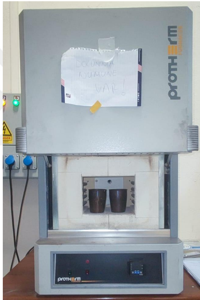
Şekil 3.9. Homojenleştirme işlemi için numunelerin fırına yerleştirilmesi.
