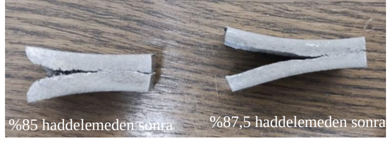
Şekil 3.12. Al7075 + %15 boraks alaşımının %100 haddeleme oranına yaklaşıldığında numunede yaşanan çatlamlar.
