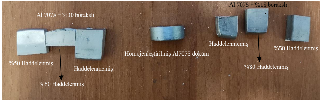
Şekil 3.13. T6 ısıtıl işlem için hazırlanan numuneler.
