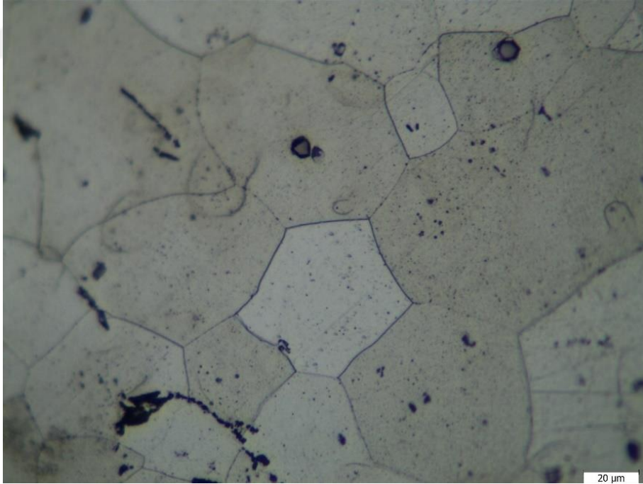
Şekil 5.35. 72 saat T6 ısıt işlem görmüş %50 haddelenmiş %30 borakslı Al7075 50 X büyütmede metalografik görünümü.
