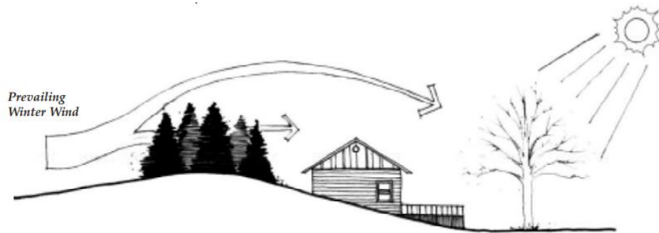
Şekil 2.3 : Kış rüzgârını yönlendirmek için enerji etkin tasarım (Haque ve diğ., 2004).
