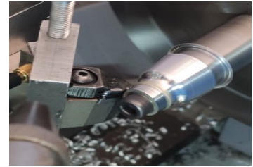
Şekil 6.4. a) Tasarım yapılan kater tutucu aparatının CNC tezgâh taretine bağlantısı b) Kater tutucu aparatın demontaj hali c) Kater tutucu aparatı d) Malzemenin derin haddeleme öncesi durumu ve bağlantı şekli e) Tasarlanan katerin torna taretine montajı işlemin yapımı
