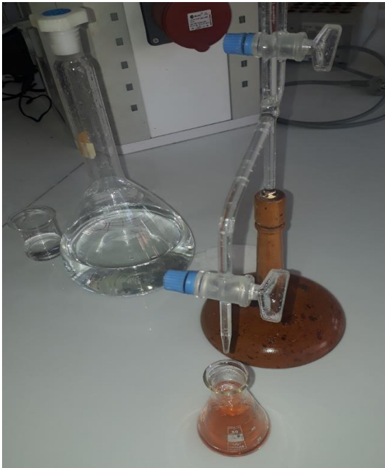
řekil 6.3. Titrasyon ile KOİ tayini
