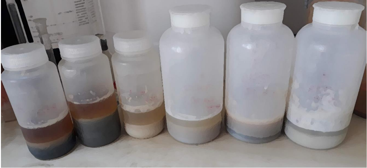
Şekil 6.6. Elektrokoagülasyon sonucu oluşan atık çamur
