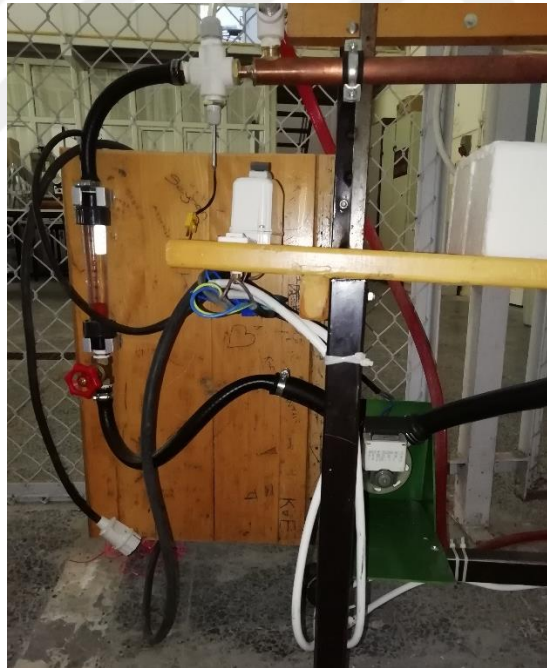
Şekil 5.13. Rotametre ve vana bağlantısı
