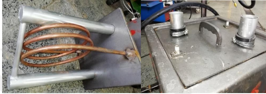
Şekil 5.10. Tank kapağına yerleştirilen alüminyum ısı değiştirici
