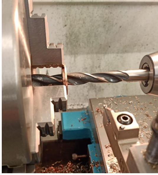
Şekil 5.4. Merkezleme elemanının işlenmesi
