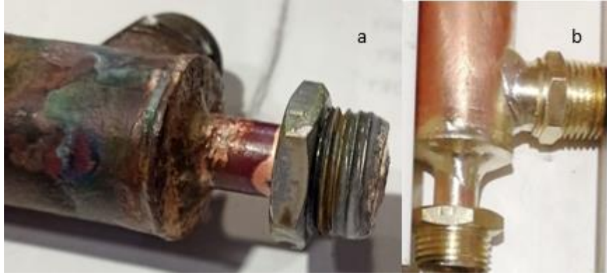
Şekil 5.6. (a) imalat sonrası parça görüntüsü, (b) temizlik işlemi sonrası görüntüsü
