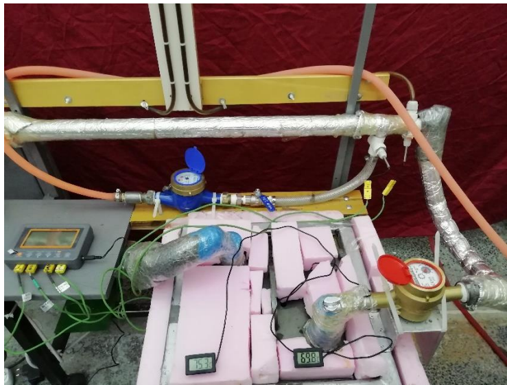
Şekil 5.15. Döner kanatlı tip debimetre bağlantısı
