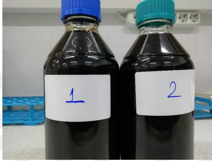
Şekil 5.18. Tek adım yöntemiyle sentezlenmiş su bazlı bakır oksit nanoakışkanı
