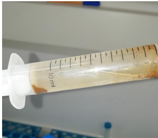
řekil 5.19. \text{Al}_2\text{O}_3 nanopartikül ilavesi sonrasında oluřan çökelmelerin numune görüntüsü
