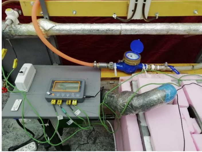
Şekil 5.16. Şebeke suyu hattına debimetre bağlantısı
