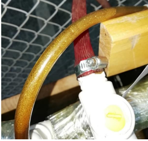
Şekil 6.19. CuO/H 2 O deneylerinde oluşan köpürmeler
