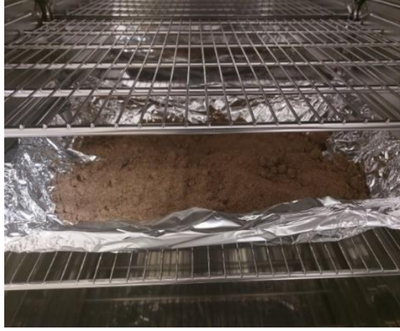
Şekil 6.5: Modifikasyona uğrayan örneklerin etüvde kurutulma işlemi.
