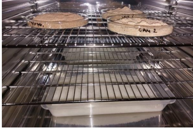
Şekil 6.3: Çam talaşı, gürgen talaşı ve PLA tozunun etüvde bekletilmesi.
