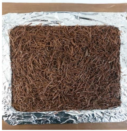
Şekil 6.7: Alüminyum folya ile sarılmış sıcak pres kalıbında talaş görüntüsü.
