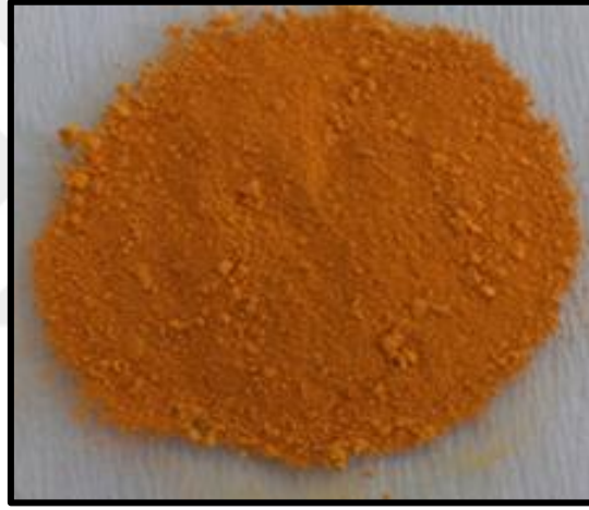
Şekil 3.2 Mikrodalga destekli reaksiyon ile sentezlen CdS nanoparçacıkların kurutma sonrası görüntüsü
