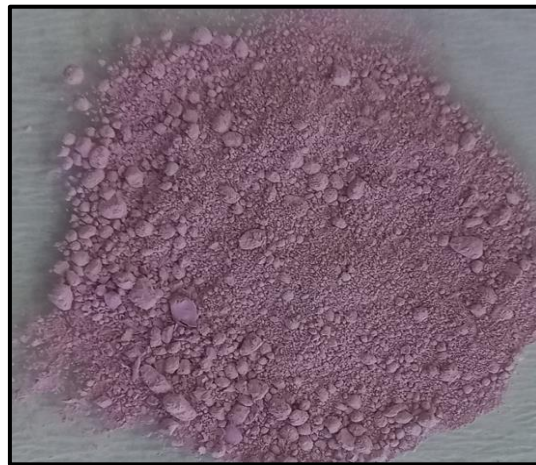
Şekil 3.6 Stokiometrik birlikte çöktürme tekniği ile hazırlanan CoSn(OH) 6 nanoküplerin kurutma sonrası görüntüsü
