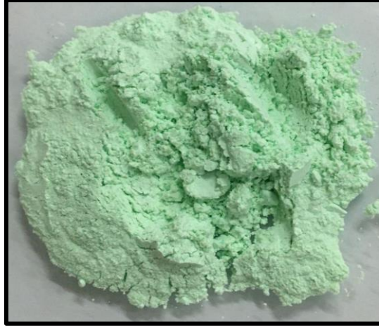
Şekil 3.4 Homojen çöktürme yöntemi ile sentezlenen \text{Ni(OH)}_2 nanoçiçeklerin kurutma sonrası görüntüsü
