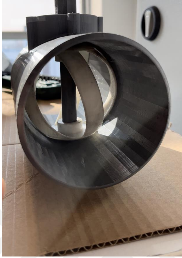
Şekil 4.8 : 3D yazıcı ile üretilmiş lucid küresel türbin sistemi.
