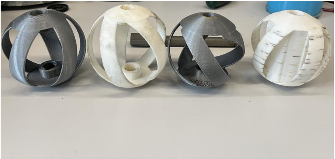
Şekil 4.9 : 3D yazıcı ile üretilmiş lucid türbinler.
