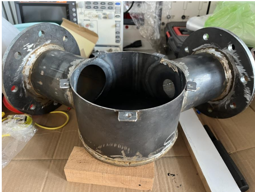
Şekil 4.16 : Lazer kesimle üretilen parçalarıyla montajı yapılmış türbin tamburu.
