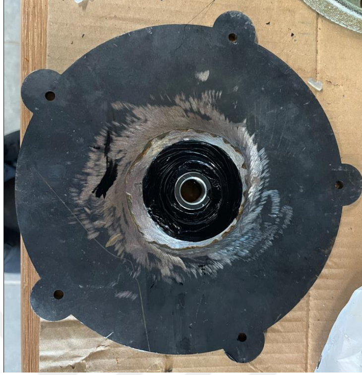
Şekil 4.17 : Lazer kesimle üretilmiş tambur kapağı (Sıvı conta ile rulman takılmış).
