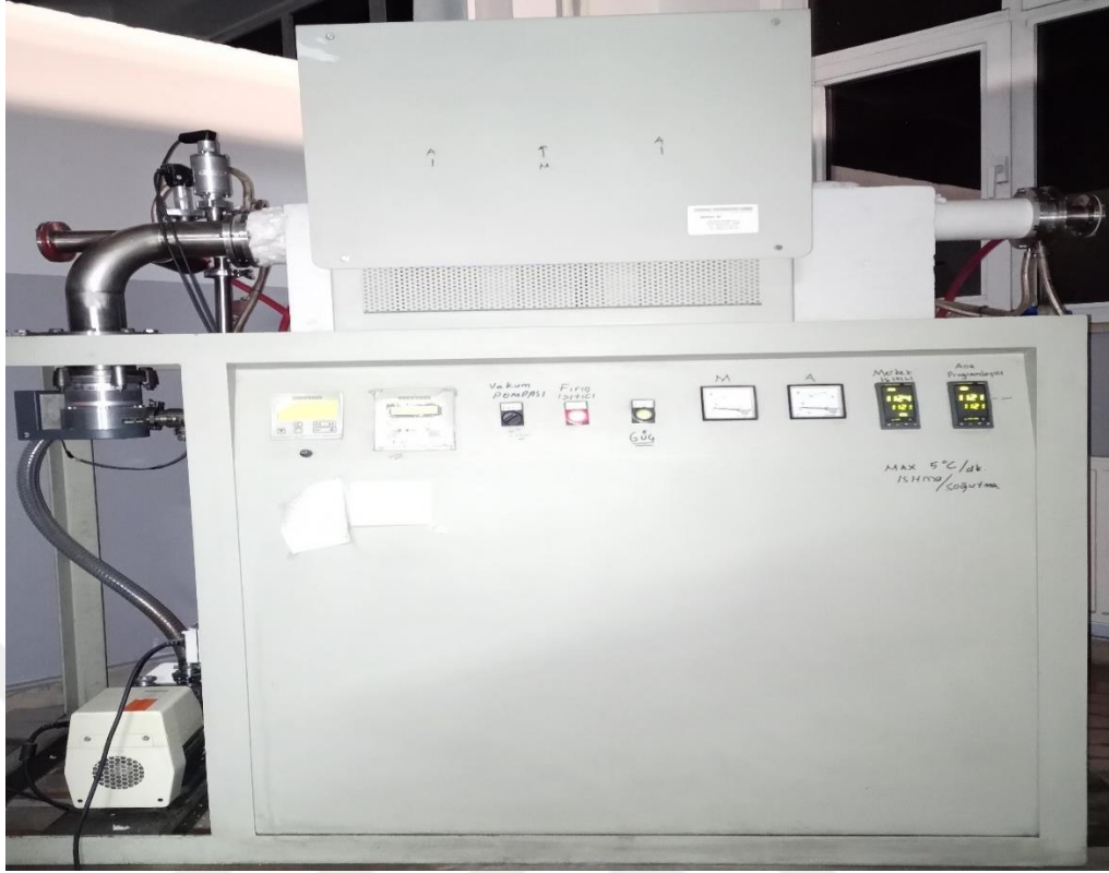
Şekil 5.3. Süperalaşım numunelerin sinterlendiği vakumlu sinter fırını.
