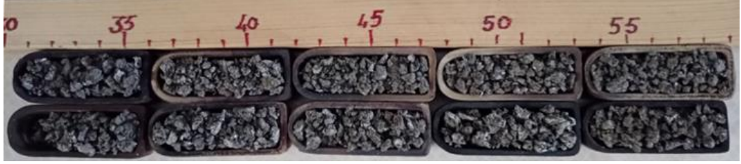
Şekil 5.5. \text{Al}_2\text{O}_3 kayıkçıklara yerleştirilmiş numuneler (sinterleme sonrası).
