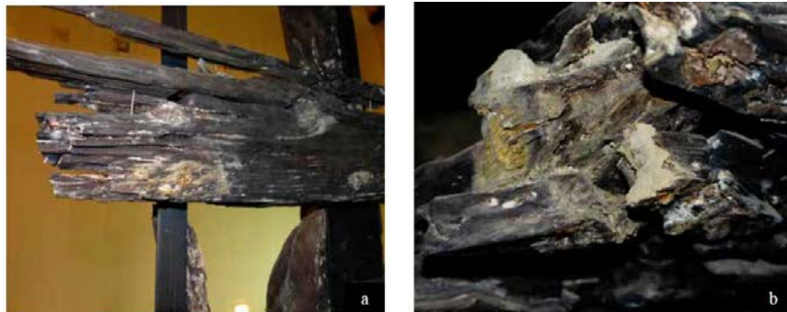
Şekil 1.30: Serçe Limanı Batığı'nda demir sülfür kaynaklı bozulmalar.
