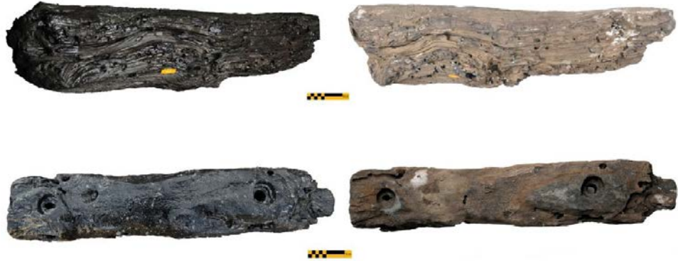
Şekil 1.27: PEG ön emdirmeli dondurarak kurutma tekniği uygulanan Çamaltı Burnu 1 gemi elemanları, konservasyon öncesi (sol), konservasyon sonrası (sağ).
