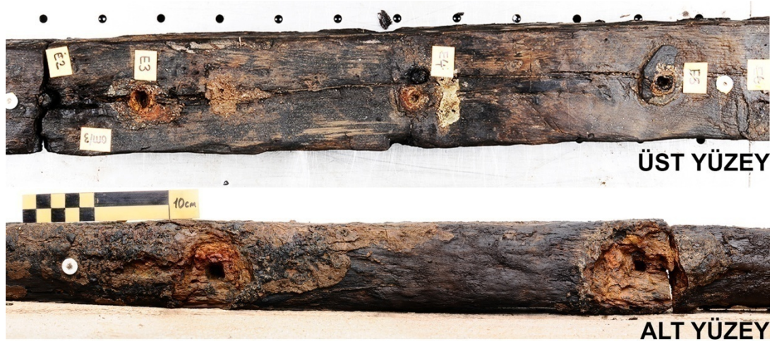
Şekil 1.10: Yenikapı 6 batığı omurga elemanlarında korozyon tabakaları.
