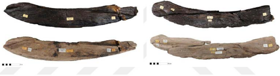
Şekil 1.29: Kauramin tekniği uygulanan YK3 gemi elemanları, konservasyon öncesi (üst), konservasyon sonrası (alt).
