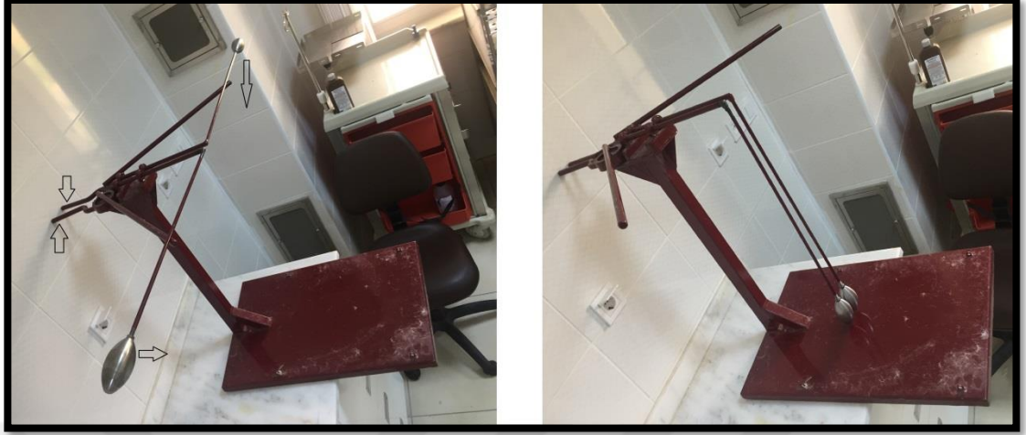
Resim 6 Modifiye Bilateral Künt Toraks Travması Modeli Mekanizması
