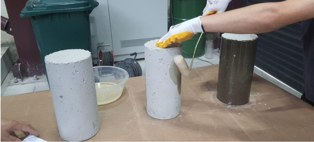
Şekil 2.5. Astar malzemesinin beton yüzeylere uygulanması
