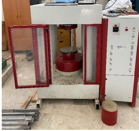
Şekil 2.15. Deneyde kullanılan basınç makinesi
