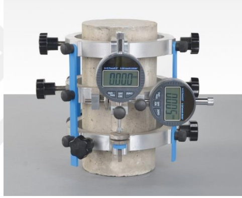
Şekil 2.14. Deneylerde kullanılan kompressometre (URL-4, 2023).
