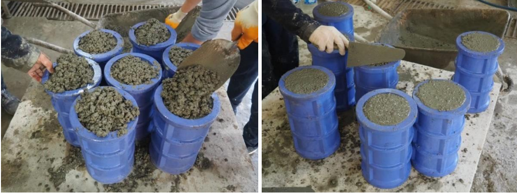
Şekil 2.3. Üretilen betonun kalıplara doldurulması ve üst yüzeylerinin düzlenmesi
