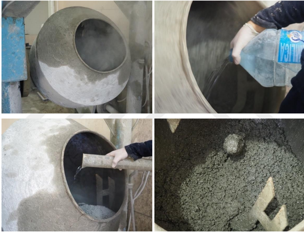
Şekil 2.2. Üretimde kullanılan mikser kazanı, ilave malzemeler ve kazan içerisindeki betonun durumu
