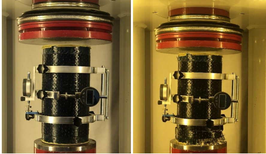
Şekil 2.18. [2]-CW-2 numunesinin basınç testi öncesi ve sonrası görüntüsü
