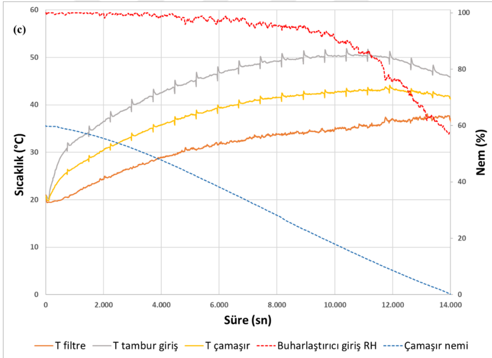
Şekil 3.35 Proses havası sıcaklık-nem ve çamaşır nem grafiği, (a)4 kg, (b)6kg, (c)8kg (devamı)
