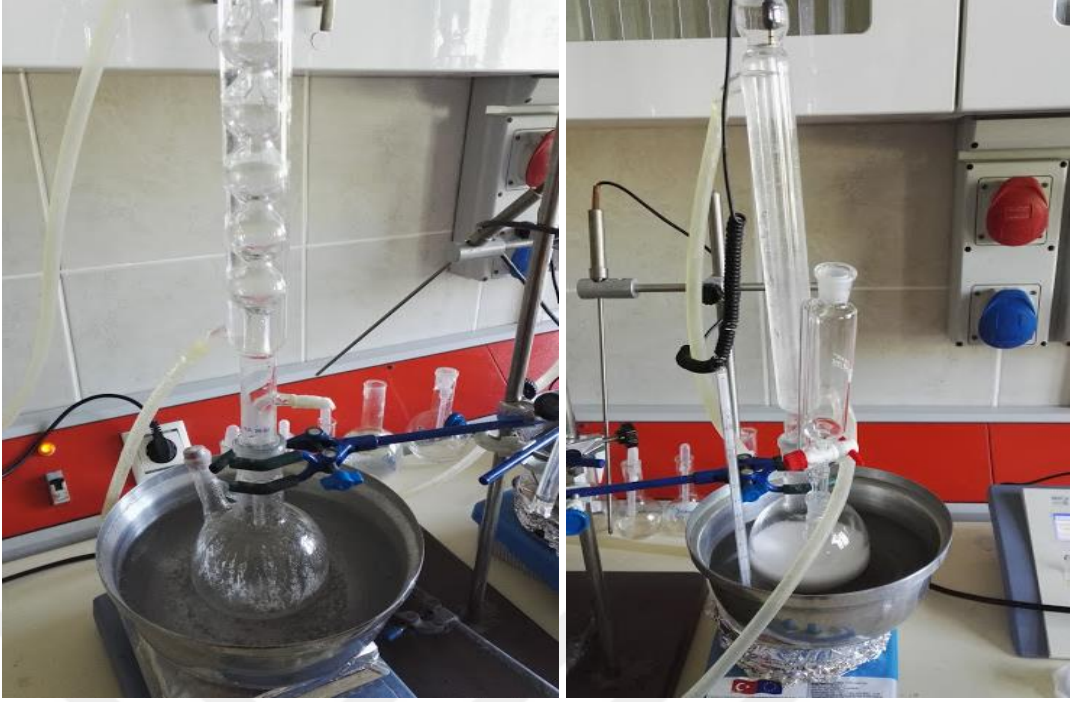
Şekil 67. Pre-polimer hazırlanması (sol) ve damlatma hunisi ile kabuk malzemesinin karıştırıcı üzerinde ortama eklenmesi
