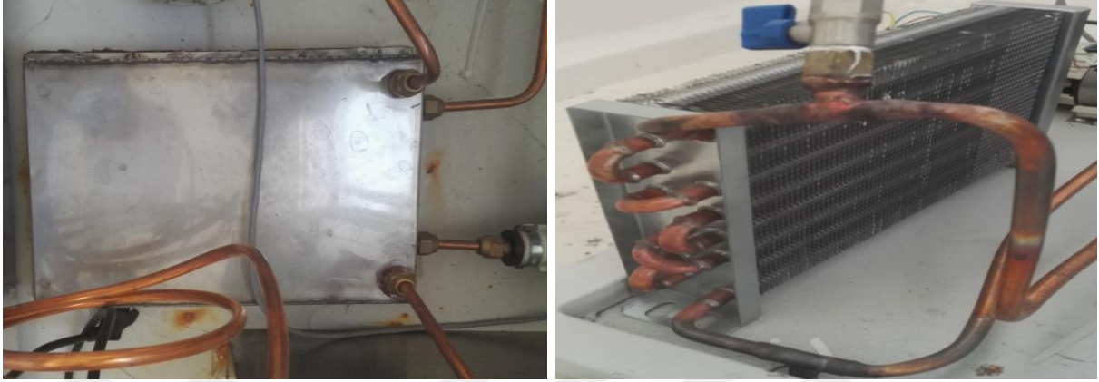
Şekil 57. Deney sisteminde yer alan kFDM-S devresi ısı eřanjörü (a) ve ikincil devre ısı eřanjörü (su-hava) (b)
