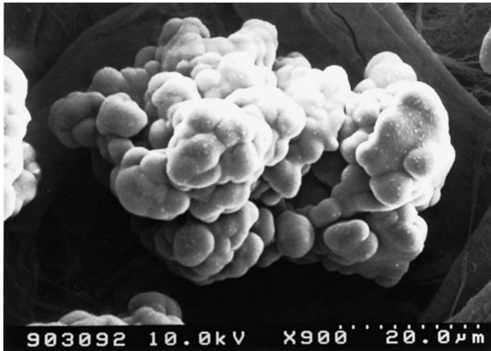
Şekil 74. Kapsüllemiş polianiline ait SEM görüntüsü (Choi, Lee, Kim, & Jhon, 2000)
