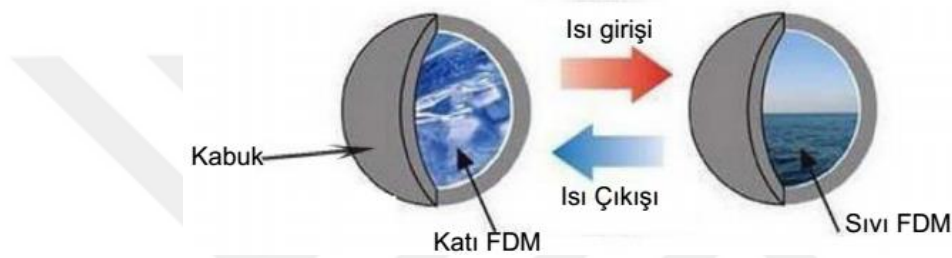
Şekil 9. Isı alışverişi sırasında kapsül içinde FDM malzemenin faz değişimi (Ghasemi et al., 2022; Qiu et al., 2017)
