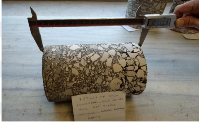
Şekil 6.17 Yoldan alınan karot numunesine ait görünüş
