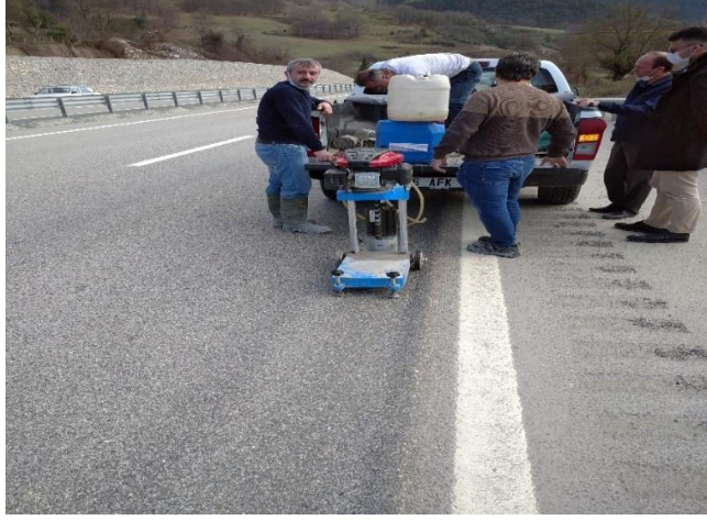
Şekil 6.16 Yoldan karot alınmasına ait görünüş
