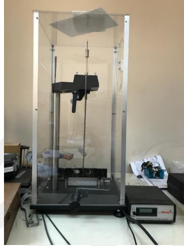
Şekil 3.11: Sertlik testi (König sarkacı).
