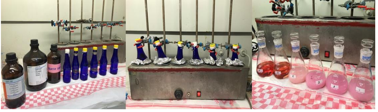
Şekil 3.7: Atık PET ara ürünlerinin hidroksil indisi analizi
