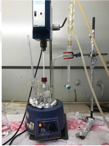
Şekil 3.4: Alkid reçine sentezi reaktör sistemi.
