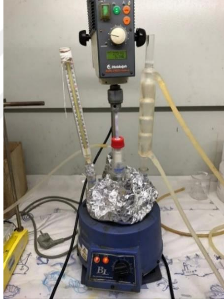
Şekil 3.1: Atık PET atmosferik basınç depolimerizasyon reaktör sistemi.
