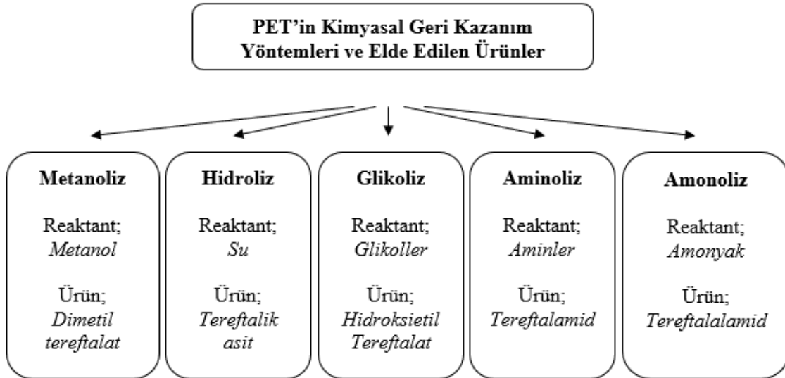
Şekil 2.8: PET'in kimyasal geri kazanım yöntemleri ve elde edilen ürünler.
