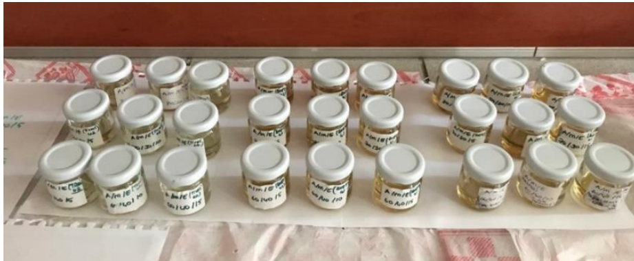
Şekil 3.5: Kısa yağlı alkid reçineler ile hazırlanan AR/MFR/ER harmanları.
