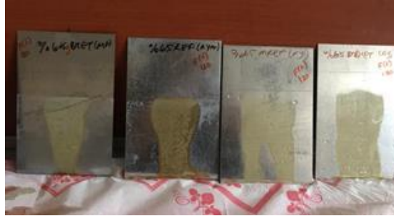
Şekil 3.16: Su dayanımı testi (destile sudan çıkarılan teneke plakaların görüntüleri).
