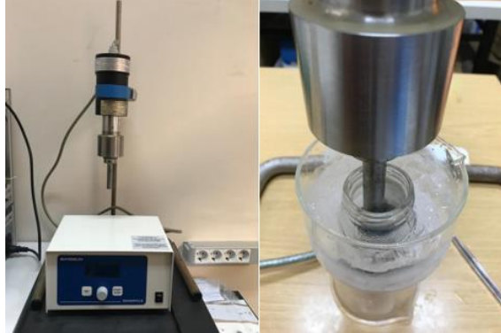
Şekil 3.6: Ultrasonik karıştırıcı ile harmanlara nanopartikül katkılarının ilavesi.
