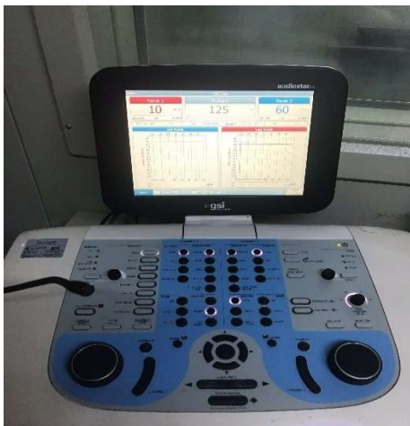
Şekil 3. 12. Çalışmada kullanılan GSI AUDIOSTAR PRO cihazı
