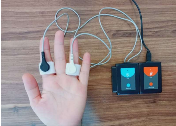
Şekil 3. 14. GSR sensörü ve USB bağlantı modülü
