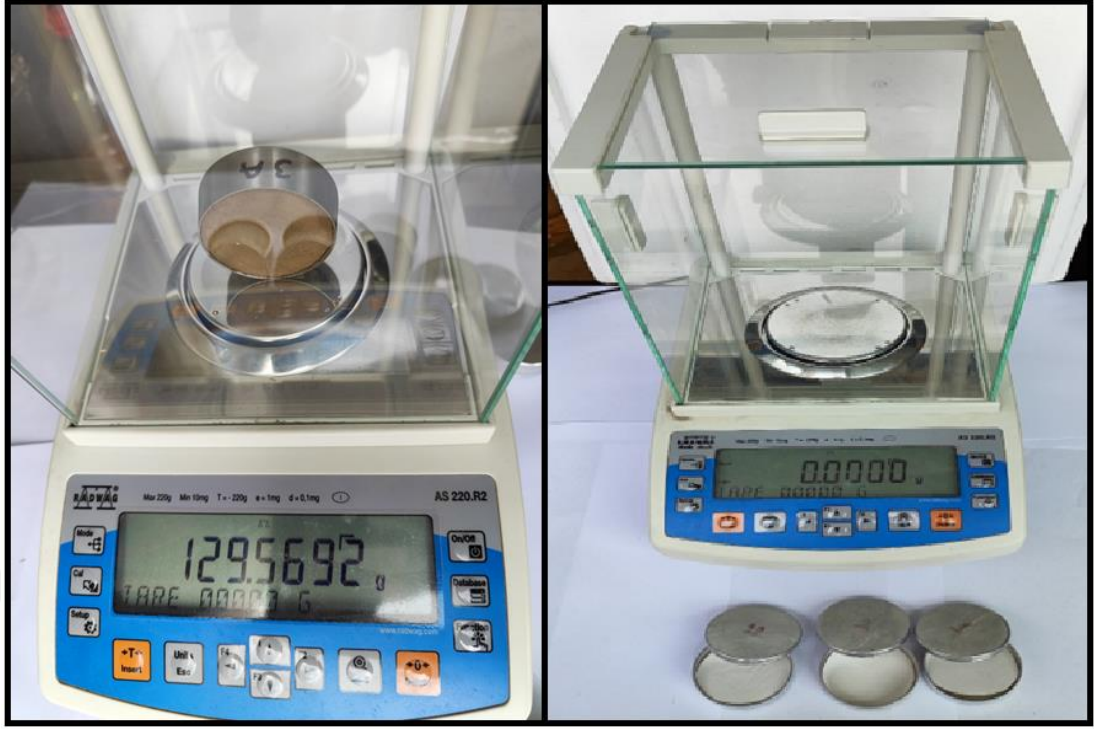
Şekil 4.7. SWCC deneylerinde kullanılan terazi ve alüminyum kaplar
