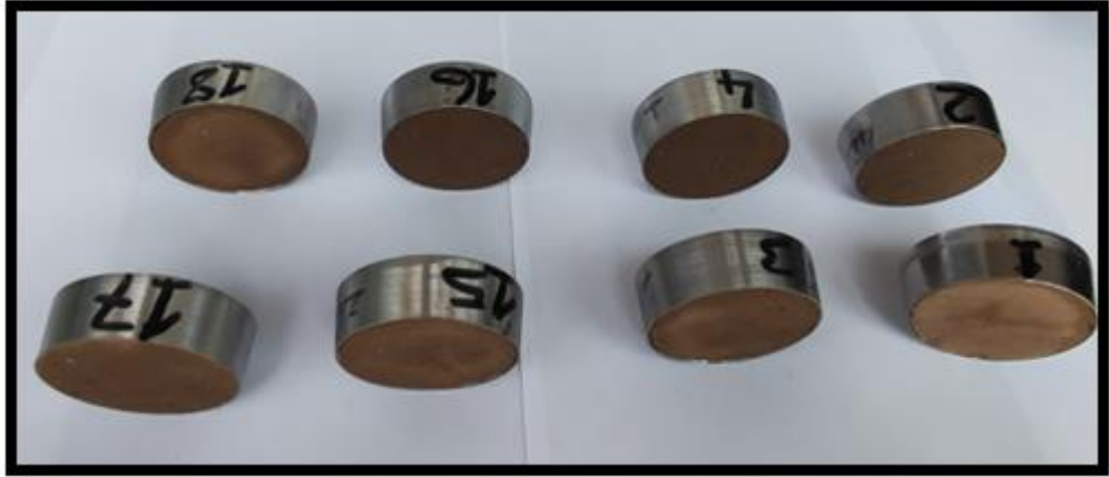
Şekil 4.8. Ölçümleri yapılan numunelerin bir sonraki aşama su muhtevası için bekletilmesi
