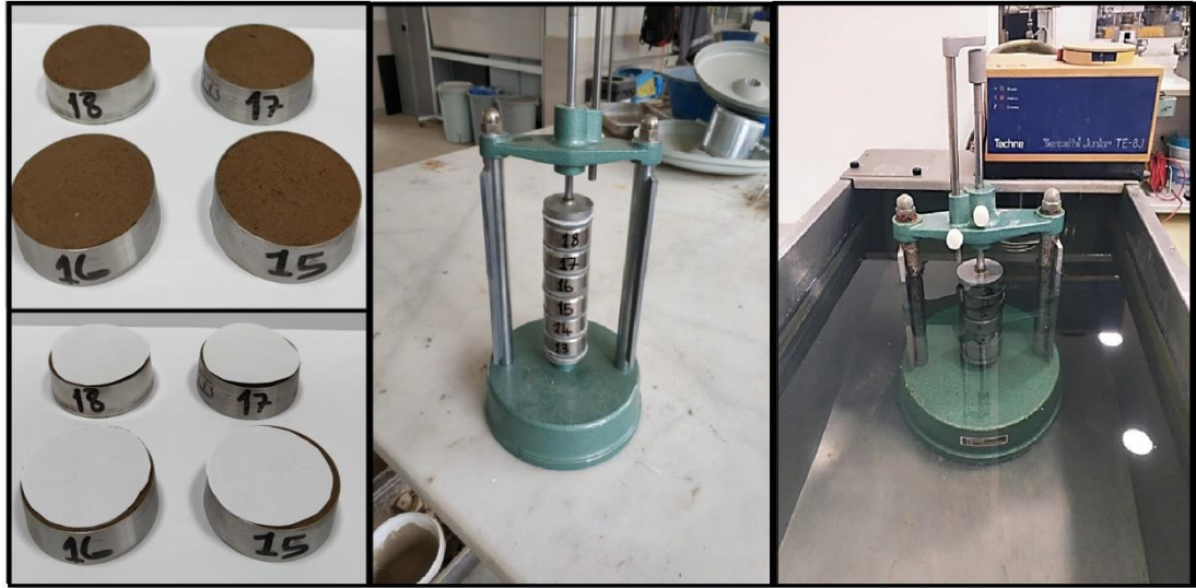
Şekil 4.3. SWC numunelerini alma ve doyurma prosedürü
