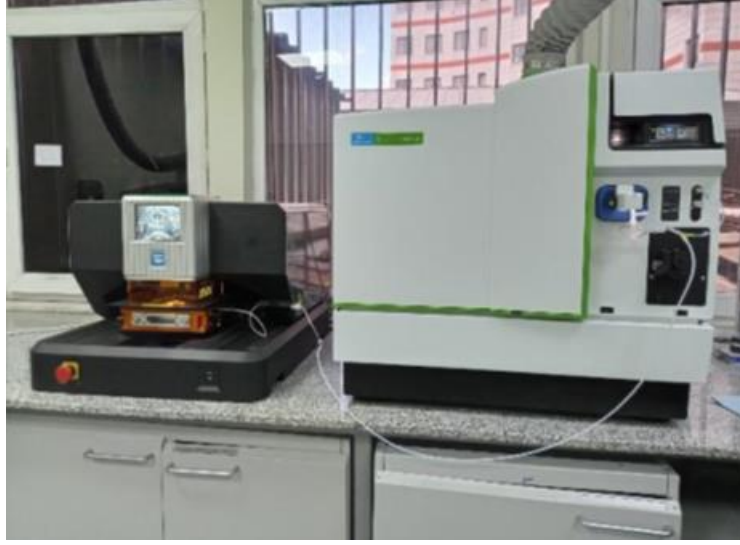
Şekil 3.21: Perkin Elmer NexION 200B (ICP-MS cihazı) ESI NWR 213 (LA cihazı).
