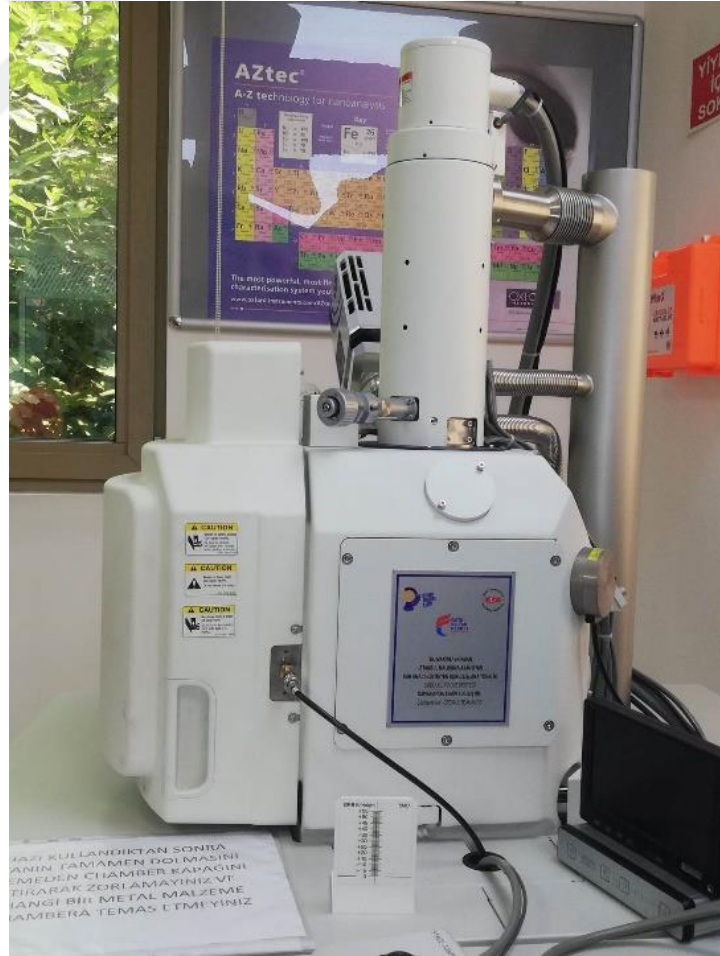
Şekil 3.20: SEM Analiz cihazı.
