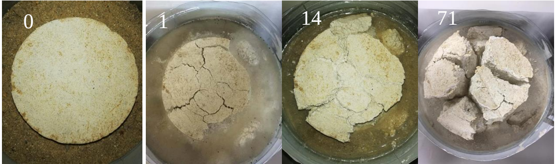
Şekil 4.13: %75 K-Brite - %25 kum- %4 kireç - % 5 kalsiyum sülfat (optimum) ve 3 gün kür.
