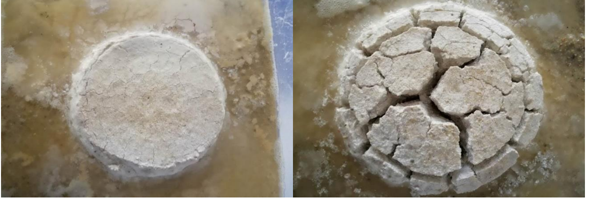
Şekil 4.11: Farklı kum yüzdelerinde serbest şişme deneyleri a) %25 Chinafill, %4 kireçli, %3.5 sodyum sülfat b) %50 Chinafill, %4 kireçli, %3.5 sodyum sülfat.
