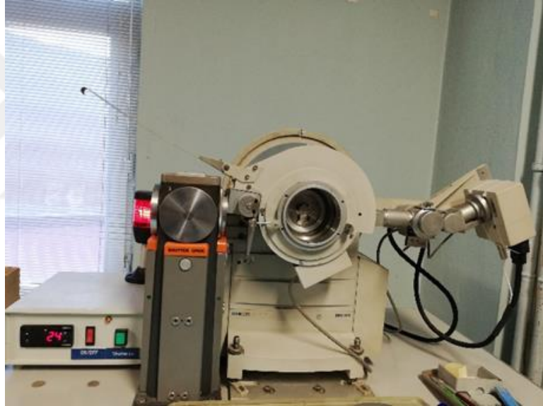
Şekil 3.17: Philips PW 1700 XRD cihazı gonyometre ve numune haznesi.
