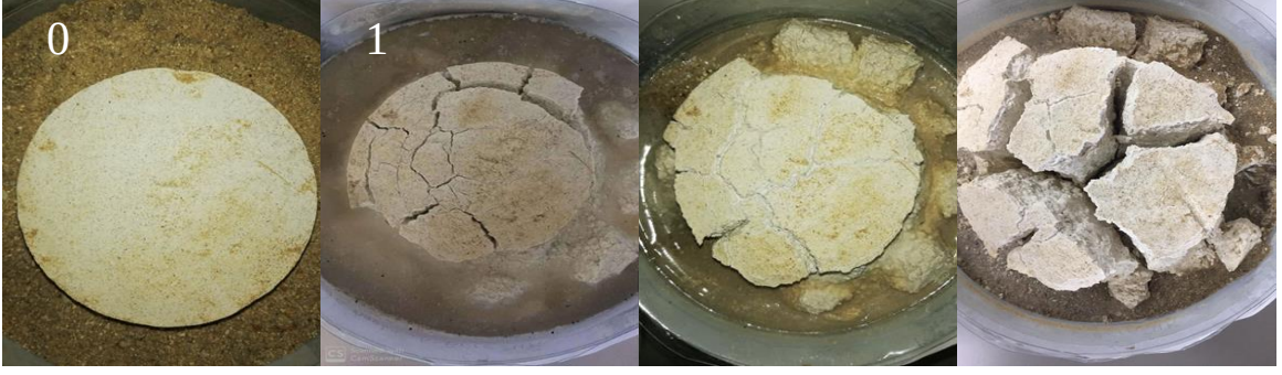
Şekil 4.14: %75 K-Brite - %25 kum- %4 kireç - %10 kalsiyum sülfat (optimum) ve 3 gün kür.
