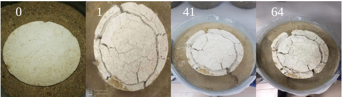
Şekil 4.17: %75 Chinafill - %25 kum - %4 kireç - %10 kalsiyum sülfat (optimum) ve 28 gün kür.
