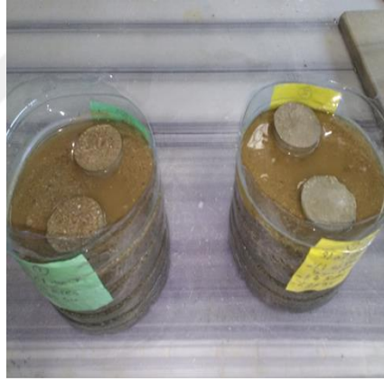
Şekil 3.6: Mukavemet deneyleri için doymuş kum ortamı içerisinde bırakılmış montmorillonit kili numuneleri.
