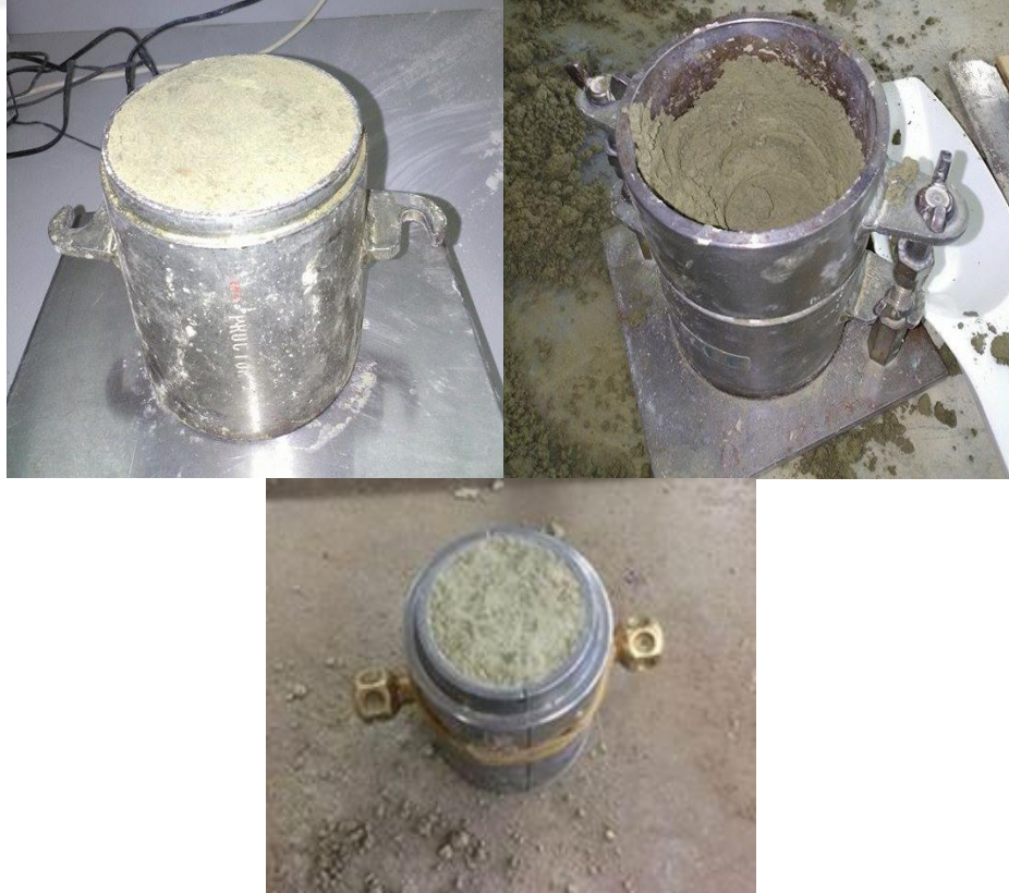
Şekil 3.4: Sıkıştırma kalıplarında hazırlanan numuneler.
