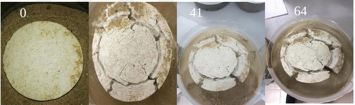
Şekil 4.16: %75 Chinafill - %25 kum - %4 kireç - % 5 kalsiyum sülfat (optimum) ve 28 gün kür.
