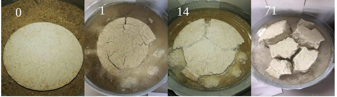
Şekil 4.12: %75 K-Brite-%25 kum - %4 kireç - % 3.5 kalsiyum sülfat (optimum) ve 3 gün kür.
