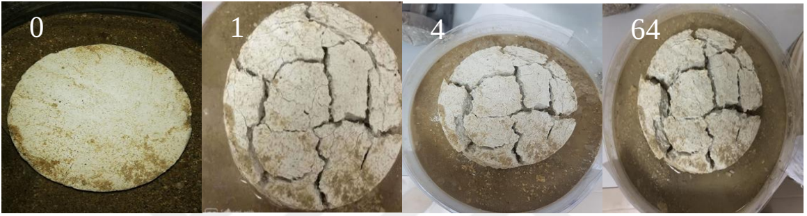
Şekil 4.15: Chinafill - %25 kum- %4 kireç- % 3.5 kalsiyum sülfat- (optimum) ve 28 gün kür.
