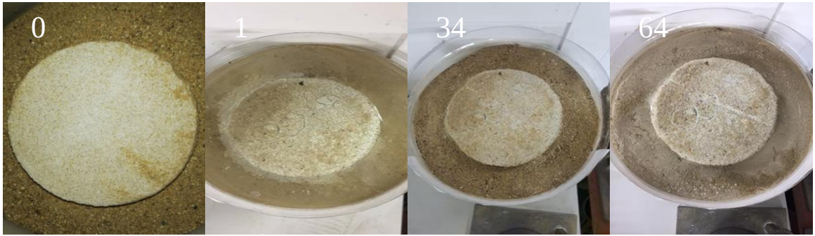
Şekil 4.20: %25 Chinafill - %75 kum - %4 kireç- %10 kalsiyum sülfat (optimum) ve 28 gün kür.
