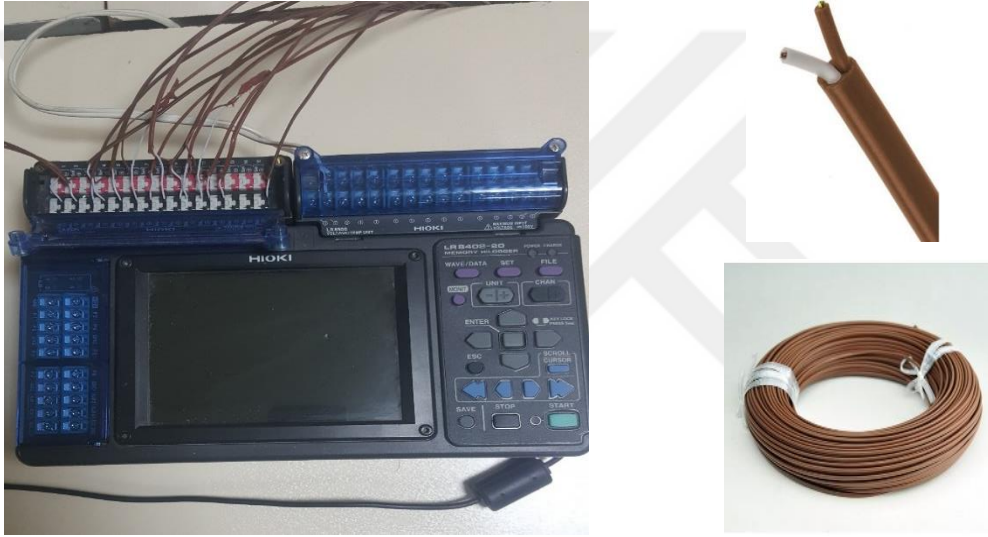
Şekil 3.7. Datalogger ve termokupul
