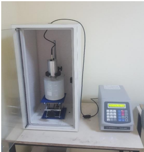
Şekil 3.3. Ultrasonik karıştırma cihazı
