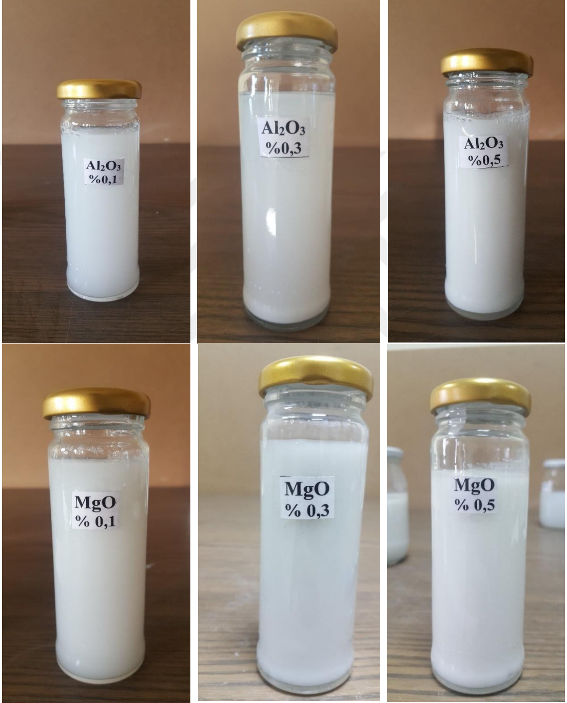
Şekil 3.4. Hazırlanan MgO ve Al 2 O 3 nano akışkanları numuneleri
