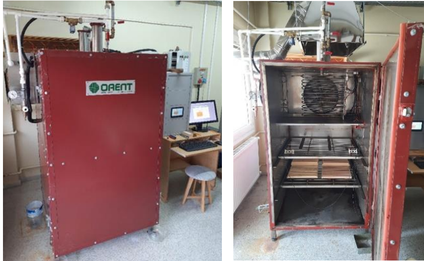
Şekil 4.5. Isıl işlem uygulamalarında kullanılan laboratuvar tipi fırın.
