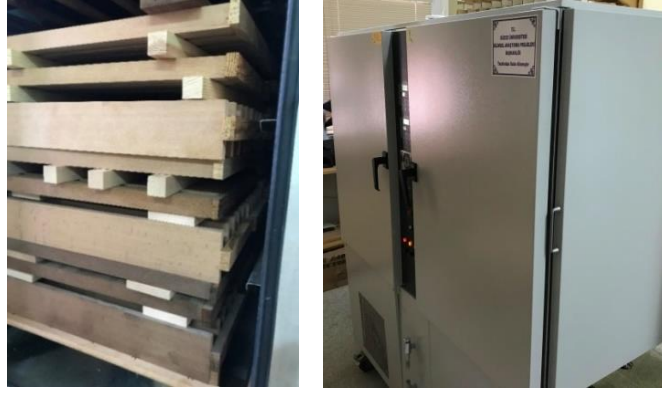
Şekil 4.2. Deney örneklerinin iklimlendirme kabininde bekletilmesi.
