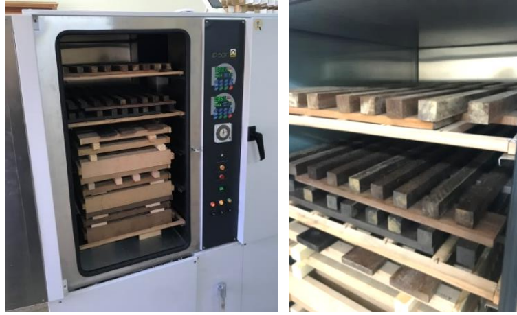
Şekil 4.8. Isıl işlem sonrası örneklerin iklimlendirme dolabında bekletilmesi.
