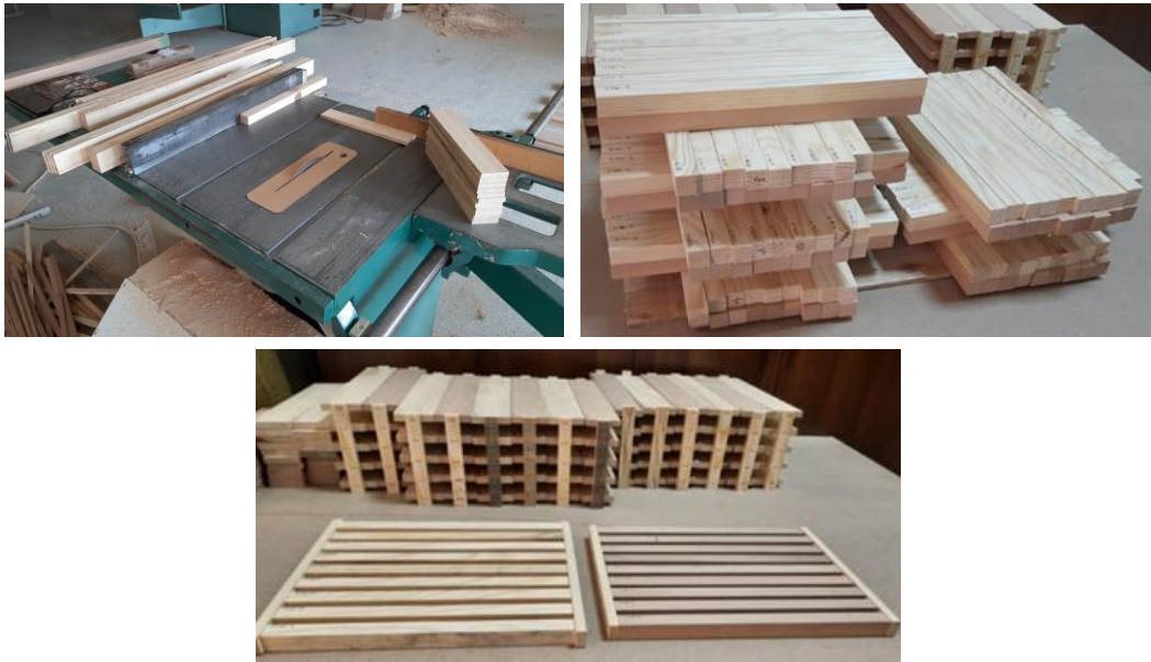
Şekil 4.1. Taslak ölçülerinde kesilmiş deney örnekleri.
