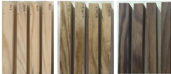
Şekil 4.7. Isıl işlem öncesi ve sonrası bazı örneklerin görünüşleri.
