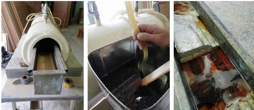
Şekil 4.3. Deney örneklerinin bezir yağı ile emprenye edilmesi.
