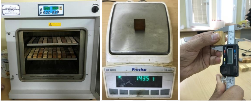
Şekil 4.9. Etüvde bekletme sonrası örneklerin ağırlık ve ölçülerinin belirlenmesi.
