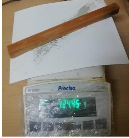
Şekil 4.4. Deney örneklerinde empenye sonrası ağırlık tartımı yapılması.
