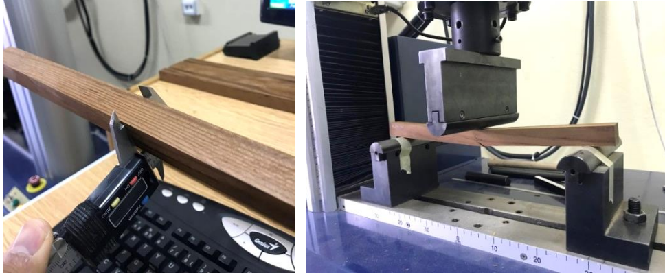
Şekil 4.12. Eğilme testi öncesi ölçüm ve test uygulaması.
