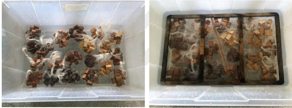
Şekil 4.10. Örneklerin distile su bulunan kaptaki bekletilmesi.
