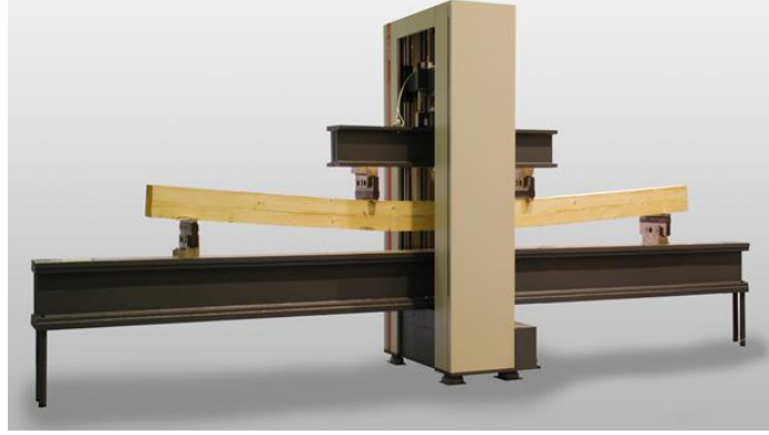
Şekil 2.8. Üniversal test cihazı ile eğilme direnci testi [26].
