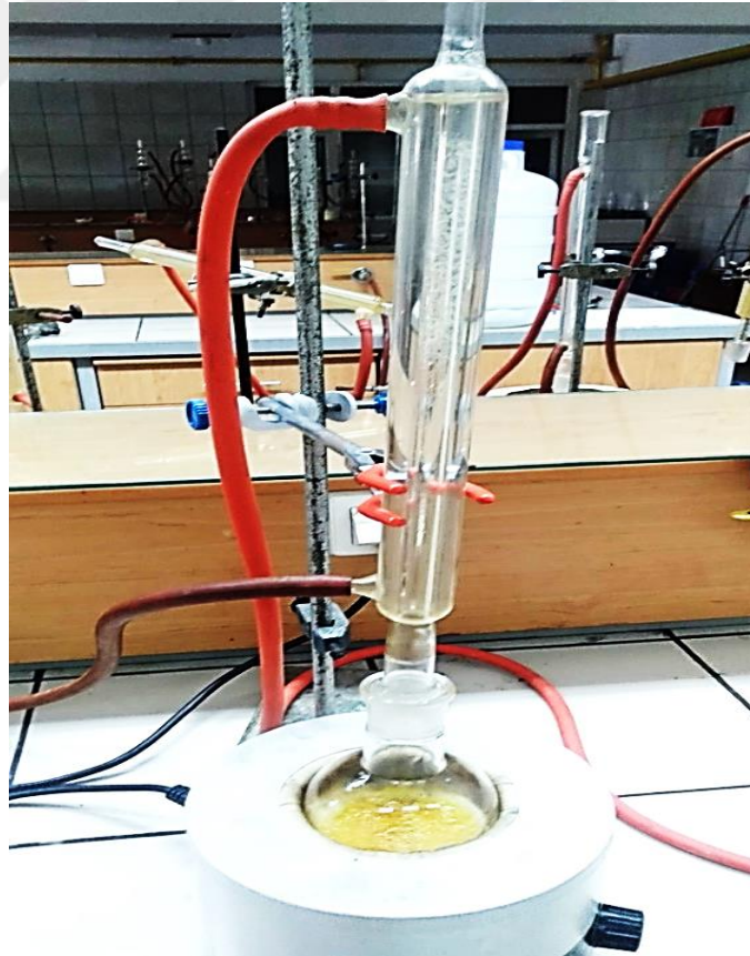
Şekil 2.21. Üzerine etanol eklenerek geri çeviren soğutucuya bağlanmış toz drog
