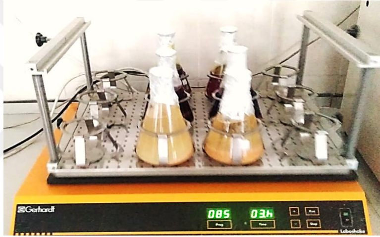
Şekil 2.27. Etanol ile hareketli maserasyona bırakılan sarımsak, zerdeçal ve üzüm çekirdeği numuneleri
