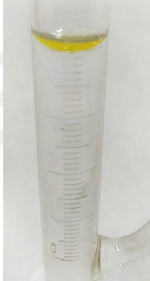
Şekil 2.19. Uçucu yağ miktar tayini cihazı ve elde edilen uçucu yağ (Clevenger düzeneği)
