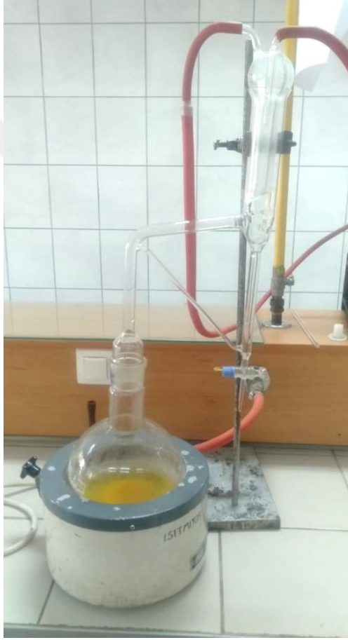
Şekil 2.19. Uçucu yağ miktar tayini cihazı ve elde edilen uçucu yağ (Clevenger düzeneği)
