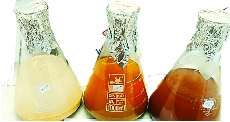
Şekil 2.26. Etanol ile 10 gün maserasyona bırakılan sarımsak, zerdeçal ve üzüm çekirdeği numuneleri
