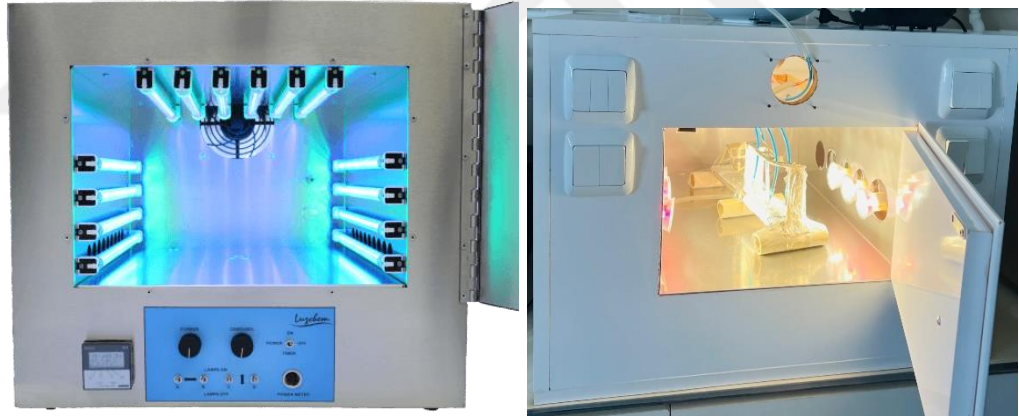
Şekil 3.2. Fotokatalitik aktivite çalışmalarında kullanılan (a) UV, (b) Görünür ışınlama kabini.
