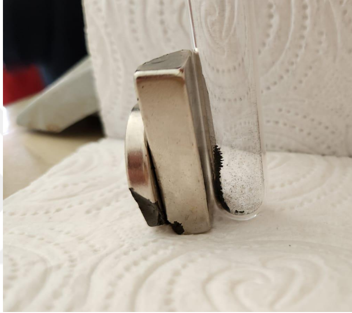
Şekil 4.10 \text{Co}_3\text{O}_4 nanopartiküllerinin neodyum mıknatısı ile manyetik özelliklerinin kontrolü.
