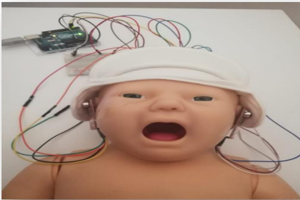
Şekil 3-5: Mikrofon sensörleri ile şapkanın gürültü azaltma testi
