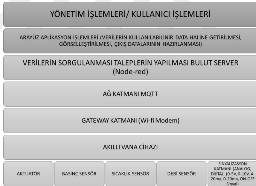
Şekil 3.3 Akıllı Vana Sistemi Mimari Yapısı
