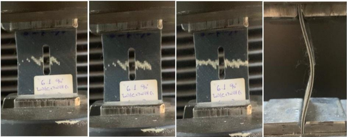
Şekil 5.24. 6.Grup (2G+4C+2G_TT) numunelerinden 90° çentik açılı numunenin hasar anı görselleri
