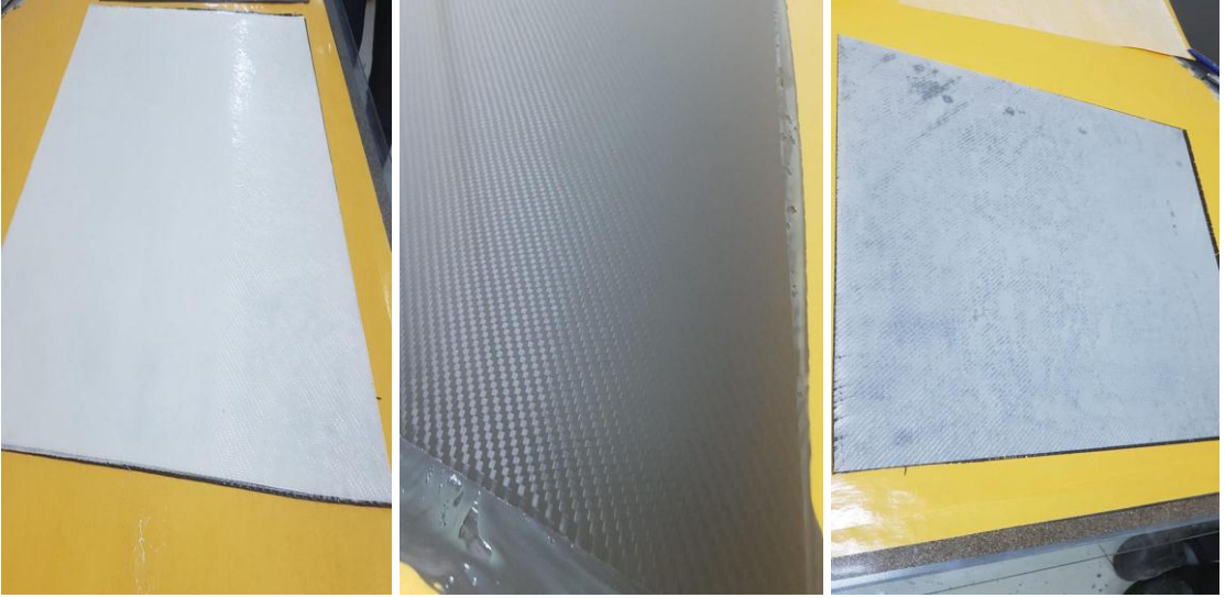
Şekil 4.4. Elyaf tabakalarının tezgâha yatırıldığı soğumaya bırakıldığı görselleri
