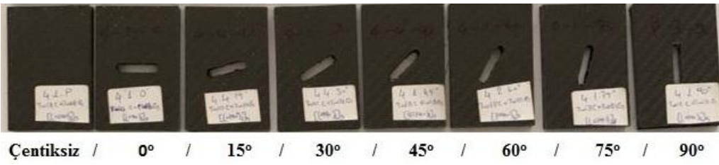
Şekil 4.9. 4.Grup numunelerin çentik açılarını detaylı gösteren görsel
