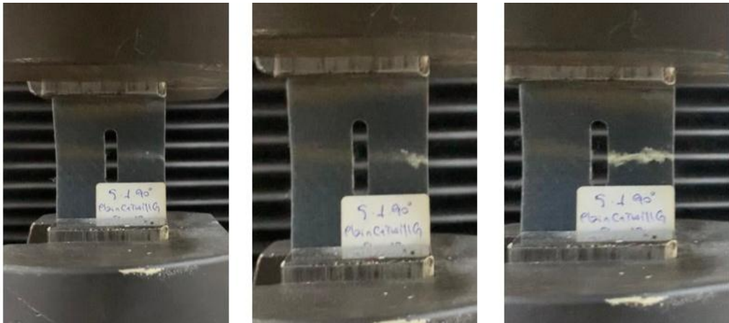
Şekil 5.17. 5.Grup (2G+4C+2G_PT) numunelerinden 90° çentik açılı numunenin hasar anındaki görselleri
