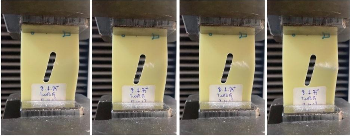
Şekil 5.39. 8.Grup (8G_T) numunelerinden 75° çentik açılı numunenin hasar anı görselleri
