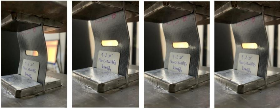
Şekil 5.14. 5.Grup (2G+4C+2G_PT) numunelerinden 0^\circ çentik açılı numunenin hasar anındaki görselleri
