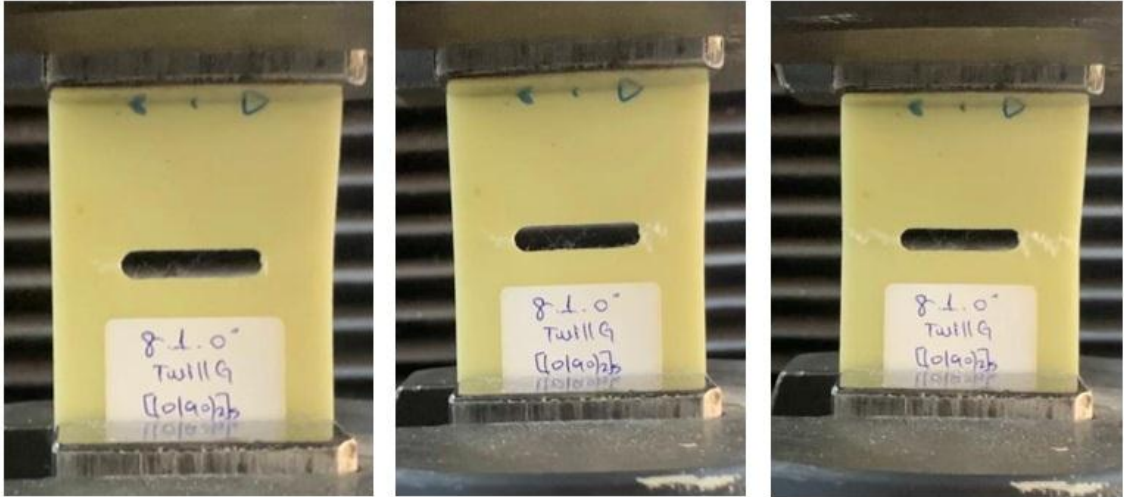
Şekil 5.34. 8.Grup (8G_T) numunelerinden 0° çentik açılı numunenin hasar anı görselleri
