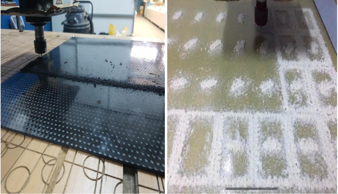
Şekil 4.5. Çentik açılarının belirlenip kesilme anındaki görselleri
