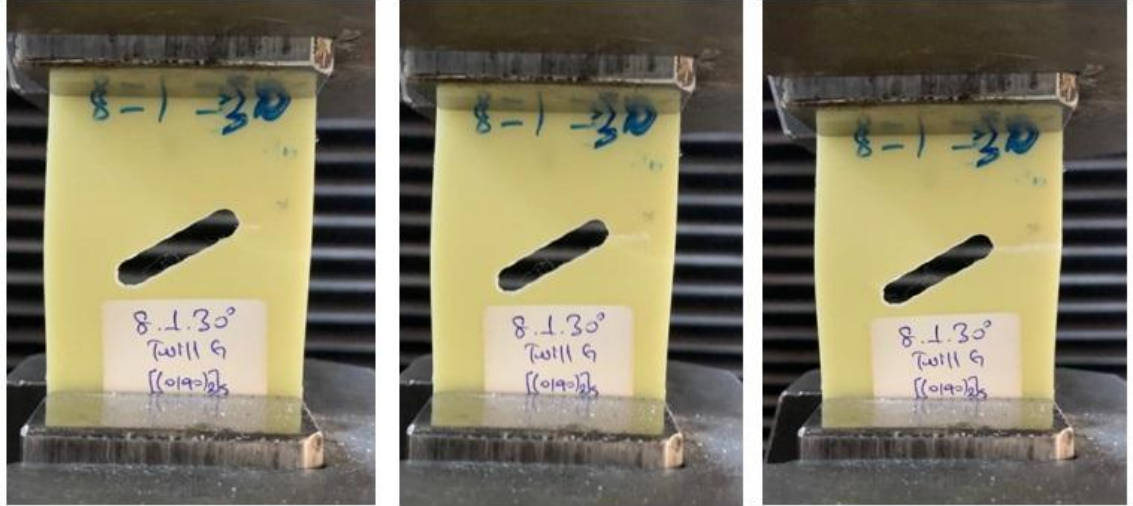
Şekil 5.36. 8.Grup (8G_T) numunelerinden 30° çentik açılı numunenin hasar anı görselleri
