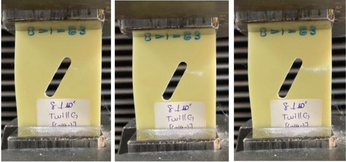
Şekil 5.38. 8.Grup (8G_T) numunelerinden 60° çentik açılı numunenin hasar anı görselleri
