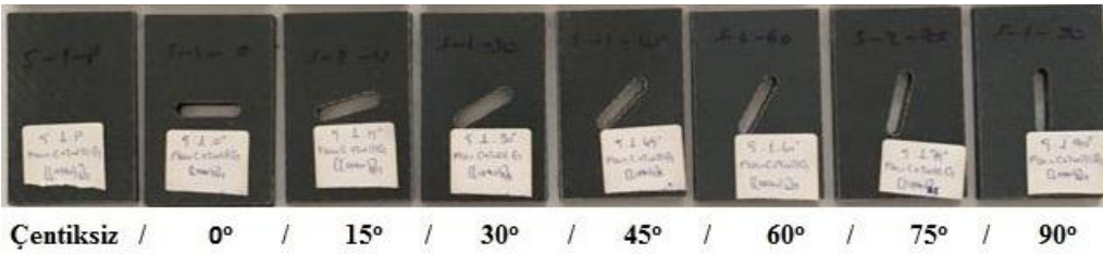
Şekil 4.10. 5.Grup numunelerin çentik açılarını detaylı gösteren görsel
