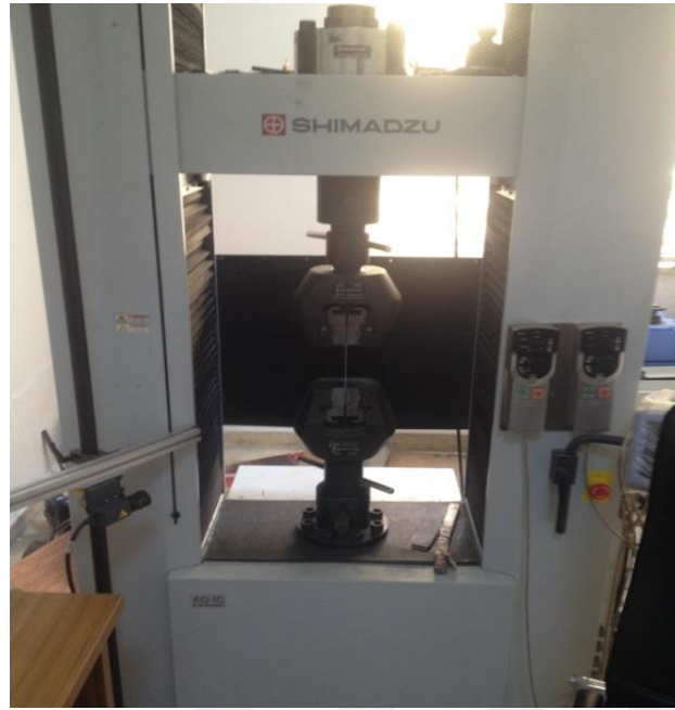
Şekil 4.15. 250 kN yük kapasiteli Shimadzu marka üniversal test cihazı
