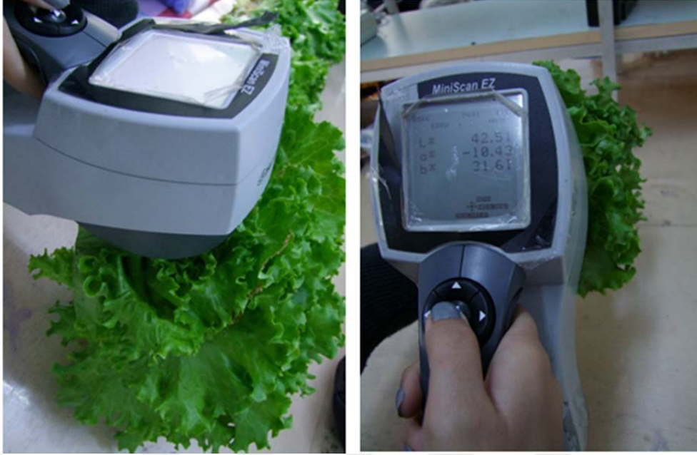
Şekil 3.10. Marul yaprakları yüzey renginde Hunter cihazı ile parlaklık ve diğer parametrelerin (L, a, b) ölçülmesi
