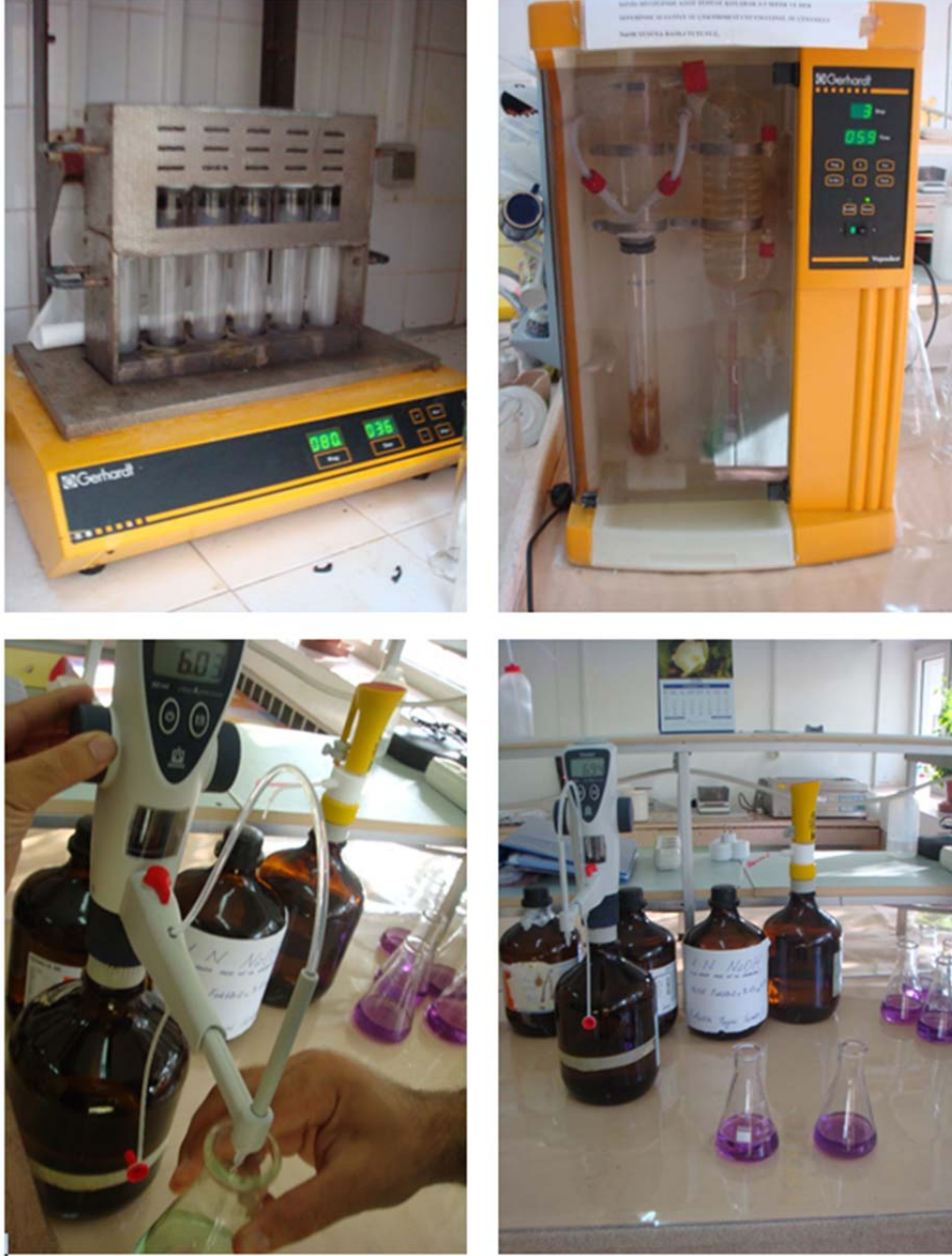
Şekil 3.15. Azot (N) analizi aşamaları; yakma, destilasyon ve titrasyon (sağdan sola ve yukarıdan aşağıya)
