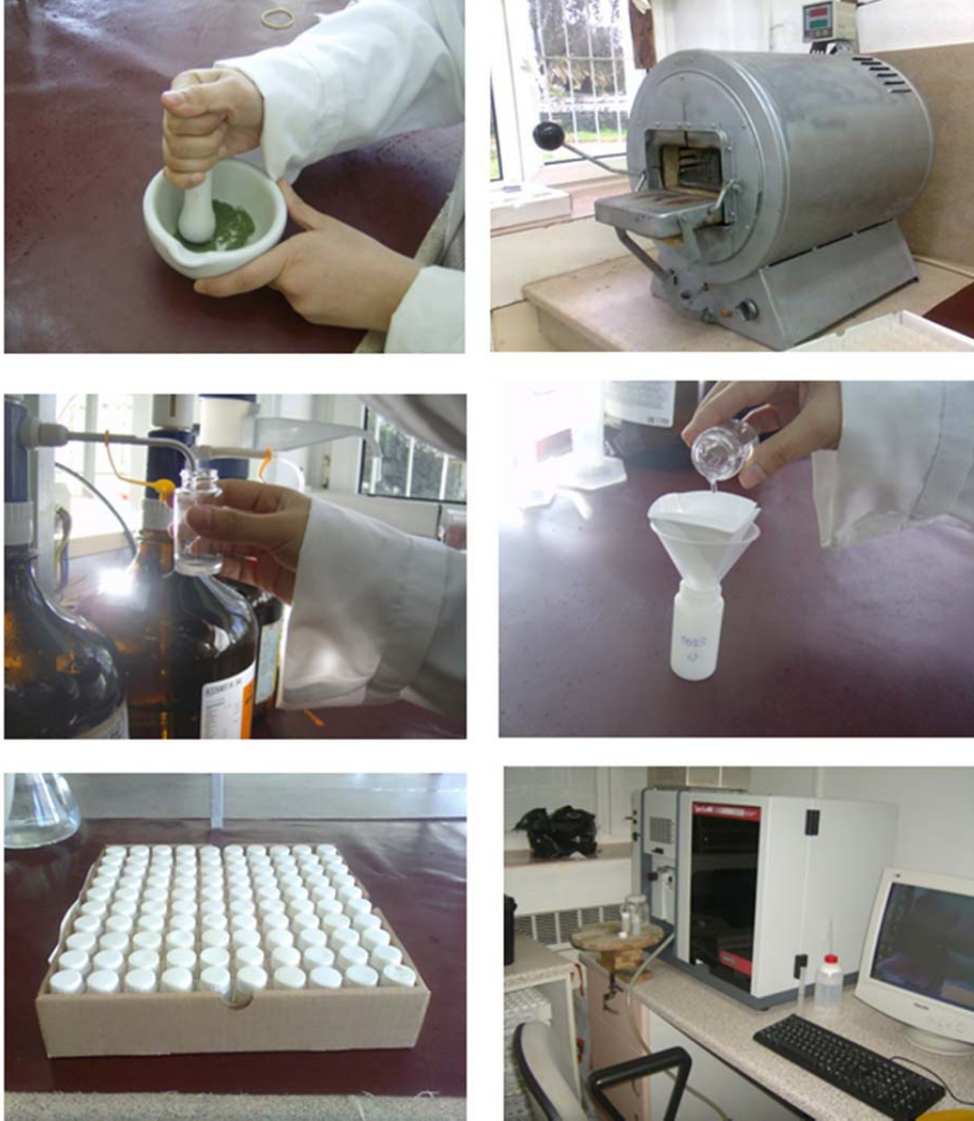
Şekil 3.16. Marul yapraklarında mineral besin maddelerinden K, Ca, Mg, Fe, Mn, Zn, Cu analizleri yapım aşamaları ve atomik absorbiyon spektrofotometre cihazı (soldan sağa yukarıdan aşağıya sırasıyla).
