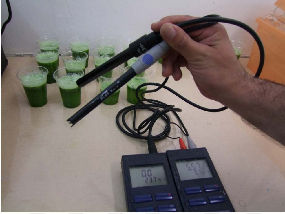
Şekil 3.13. Marul suyunda pH ve EC ölçülmesi
