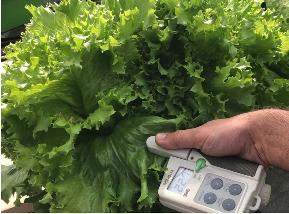
Şekil 3.11. Marul yapraklarında SPAD metre cihazı ile klorofil ölçümü
