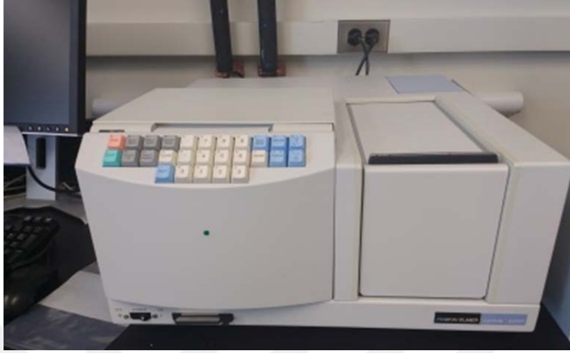
Şekil 3.14. Marul yapraklarında C vitamini, toplam fenolik madde, flavanoid, nitrat analizleri ve fosfor tayini yapılan spektrofotometre cihazı
