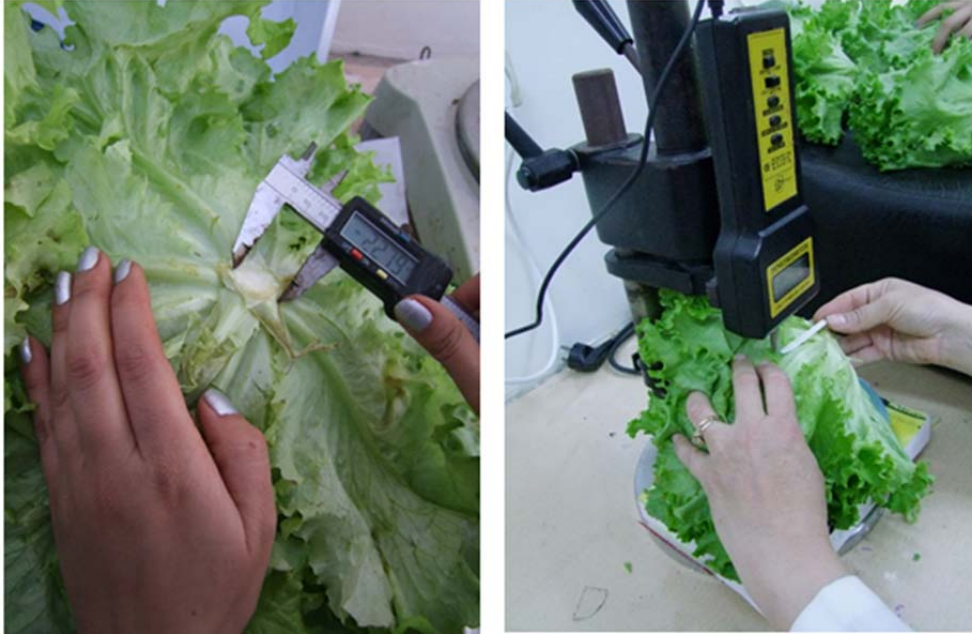
Şekil 3.8. Kıvırcık marul bitkisinde kök boğazı çapının kumpas ile ölçülmesi (sol) ve digital penetrometre ile bitkide dıştan sertlik ölçülmesi (sağ).
