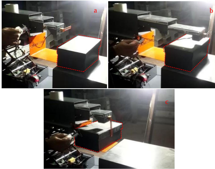
Şekil 4.5: Teleskobik Mekanizma Kutu Hareket Fonksiyon Testi : (a) Kutu Alınmadan Önceki Konum. (b) Kutu Alınma Sırasındaki Konum. (c) Kutu Alındıktan Sonraki Konum
