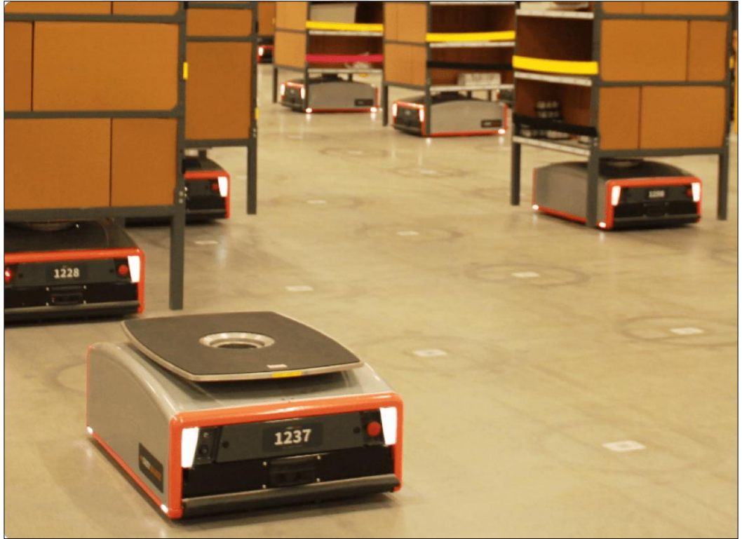
Şekil 1.2: Depo İstifleme Robotları [4]
