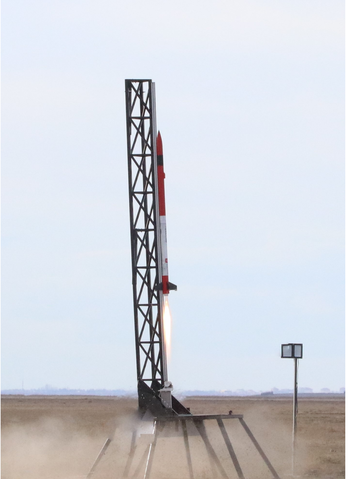
Şekil 3.19: Bu çalışmada uçuşu gerçekleştirilen hibrit yakıtlı sonda roketi
