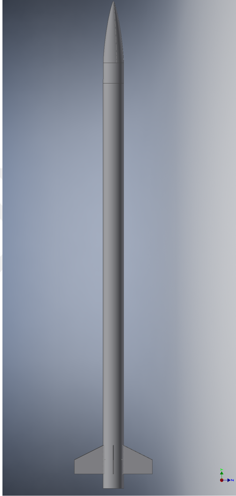
Şekil 3.10: HAD Analizleri için hazırlanan üç boyutlu roket geometrisi
